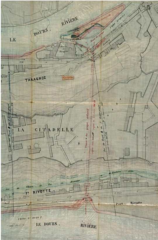
Dérivation sous la citadelle de Besançon. Plan de la dérivation et de ses abords [détail : tracé définitif, en rouge], 1877. 25, Besançon Faubourg Rivotte, lieudit : îlot Faubourg Rivotte
