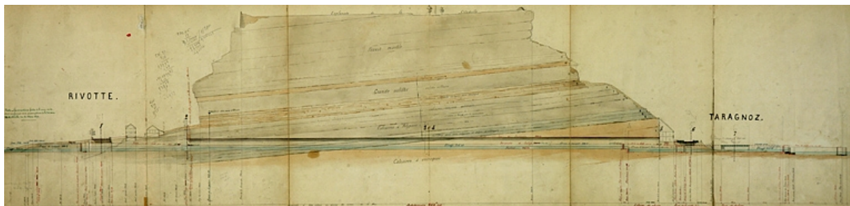
Avant-projet de dérivation sous la citadelle de Besançon [tracé A]. Profil en long, 1874.
