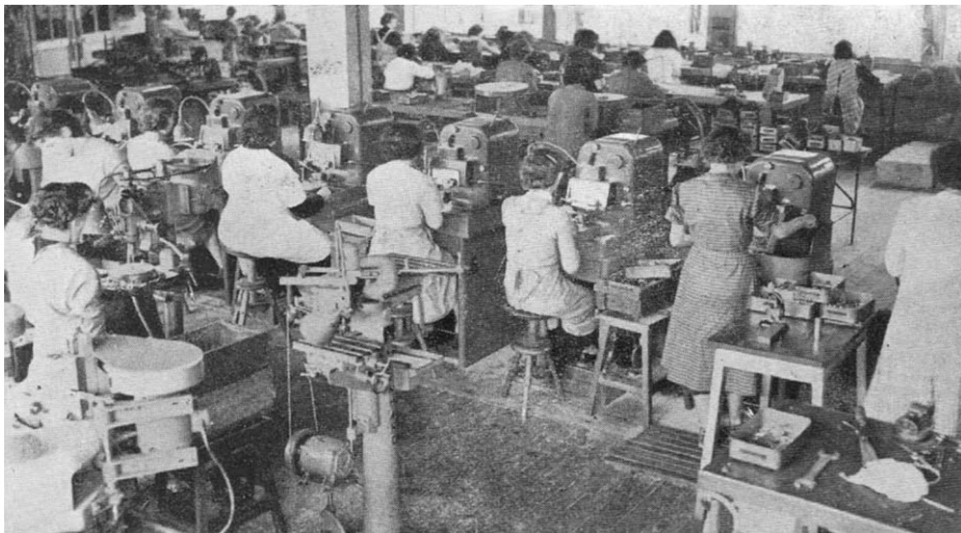
Atelier des ébauches. Batterie de contourneuses, s.d. [vers 1950].
