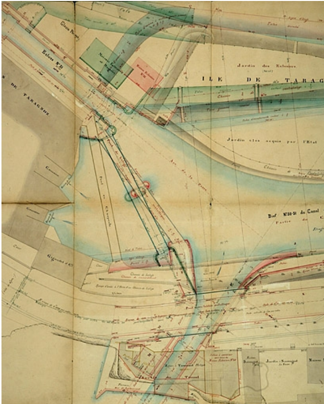
Dérivation sous la citadelle de Besançon. Plan des ouvrages à l'extrémité aval de la dérivation, 1877.
