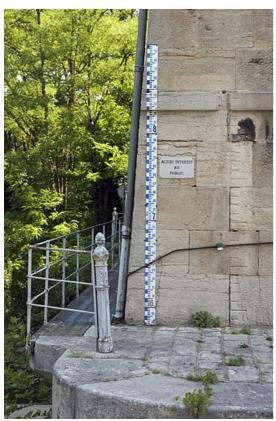
Echelle limnimétrique (ou hydrométrique).
