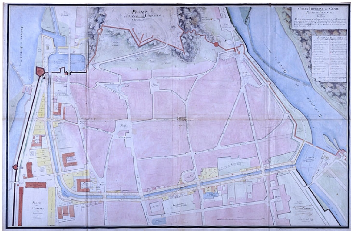
Plan d'une partie de la cité de Besançon et de ses fortifications, pour servir au projet du tracé de dérivation du canal Napoléon à travers ladite ville, 1809.
