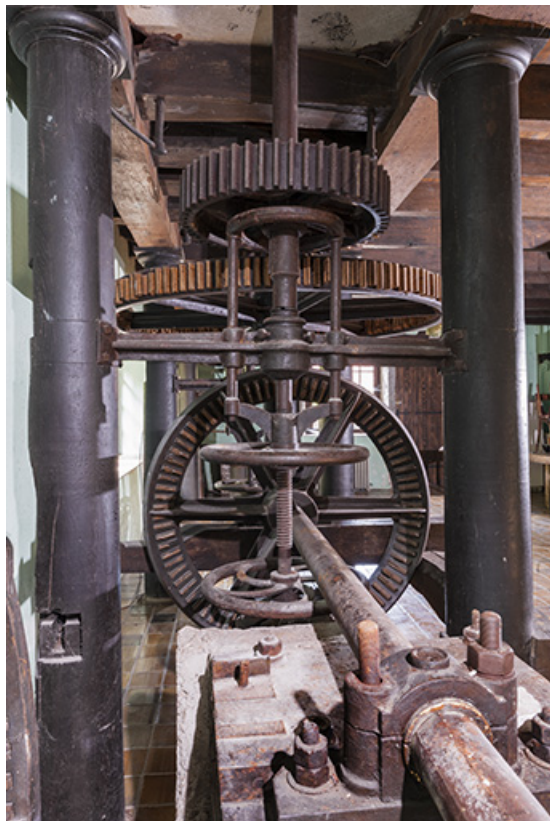
Arbre principal et système de transmission du beffroi est.
