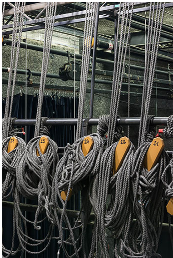
Cage de scène : fils enroulés sur des palets (taquets). 21, Dijon, 9 rue Condorcet
