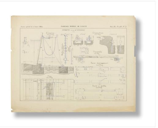
Barrage mobile de Poncey. Fermette et ses accessoires.1886.
