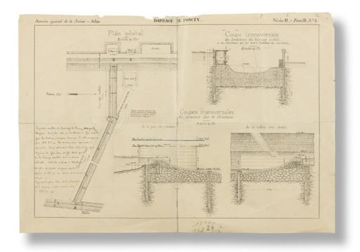
Barrage de Poncey. Plan général, coupes transversales du déversoir fixe et élévations. [Il est indiqué la localisation du magasin (à aiguilles), de la maison du barragiste et du jardin]. 1886
