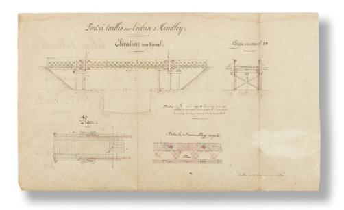
Ecluse d'Heuilley. Rétablissement du pont à treillis. Plans et détails. [Plan, coupe et élévation] 1871.
