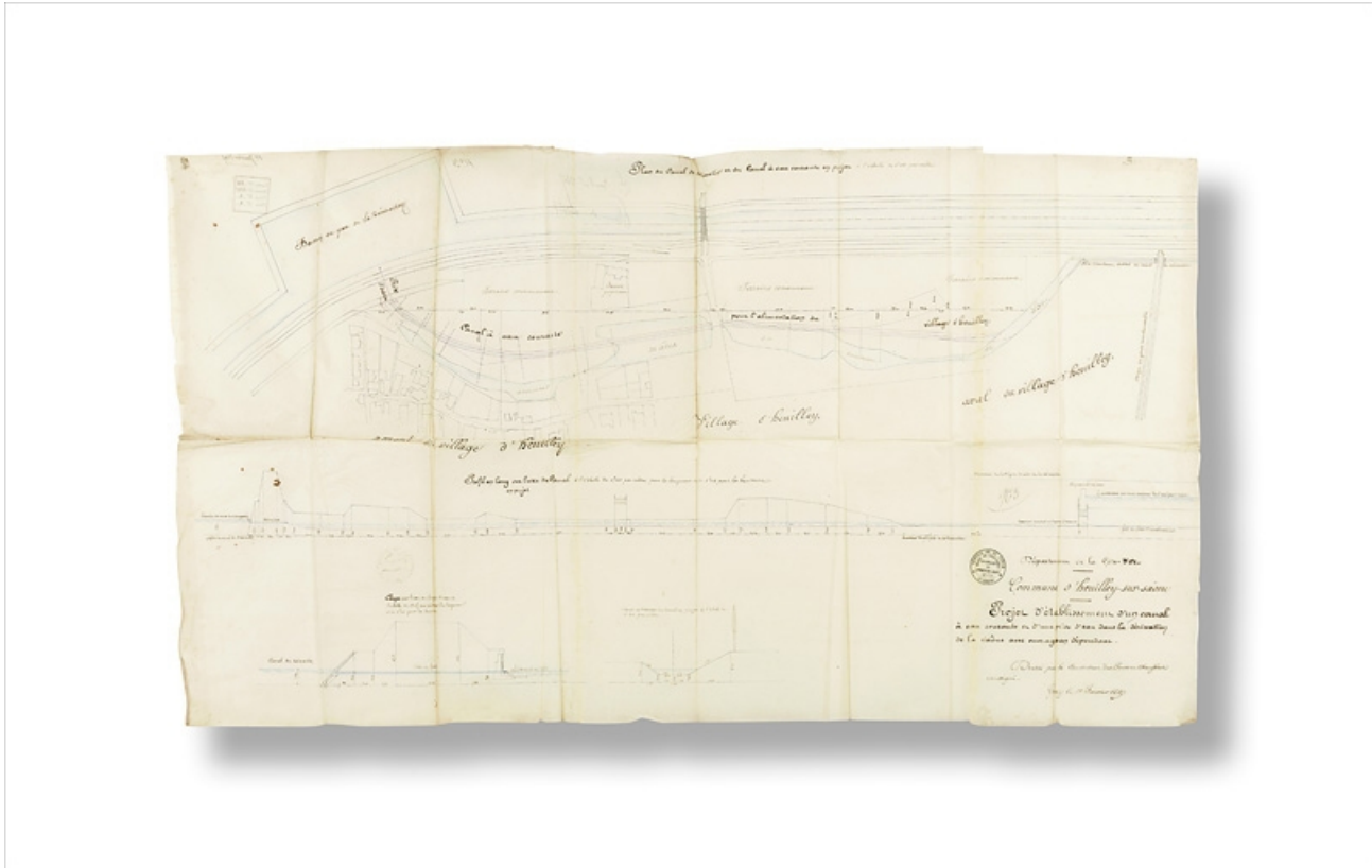
"Projet d'établissement d'un canal à eau courante et d'une prise d'eau dans la dérivation de la Saône avec ouvrages en dépendant." Plan et profil en long. 1er janvier 1847.
