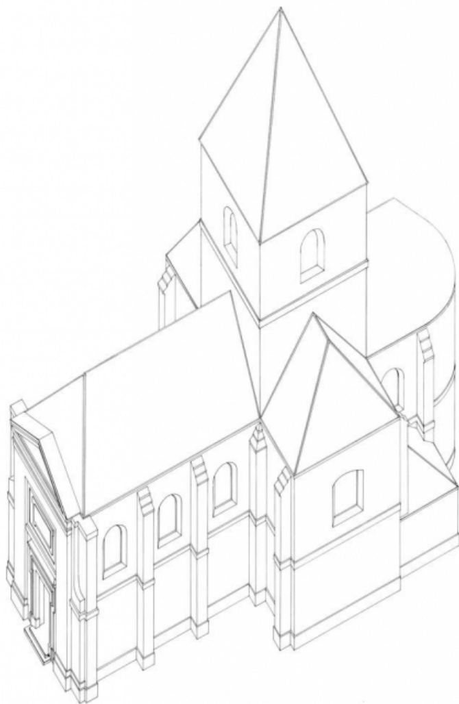
Vue axométrique de l'édifice avec le clocher à la croisée du transept, reconstitution. 21, Pommard Métairie
