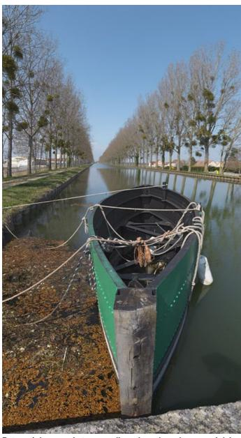
Bateau-écluse : ce bateau se glisse dans des rainures spécialement conçues à cette effet dans les bajoyers pour remplacer les portes en cas de travaux sur ces dernières.
