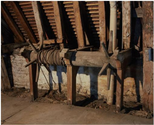
Salle de spectacle en 1996 : mécanisme du lustre (dans le comble). Ce mécanisme a été supprimé après 1996. 21, Châtillon-sur-Seine place de la Résistance
