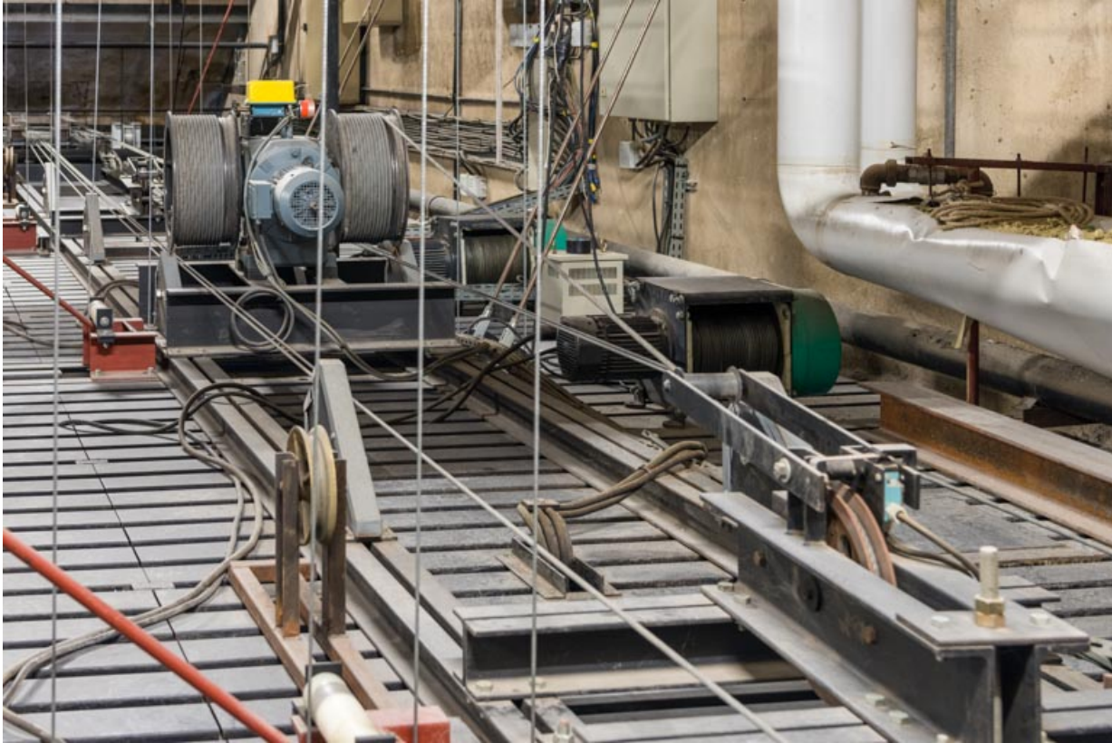
Cintre : moteur électrique d'une équipe (cadrage horizontal).
