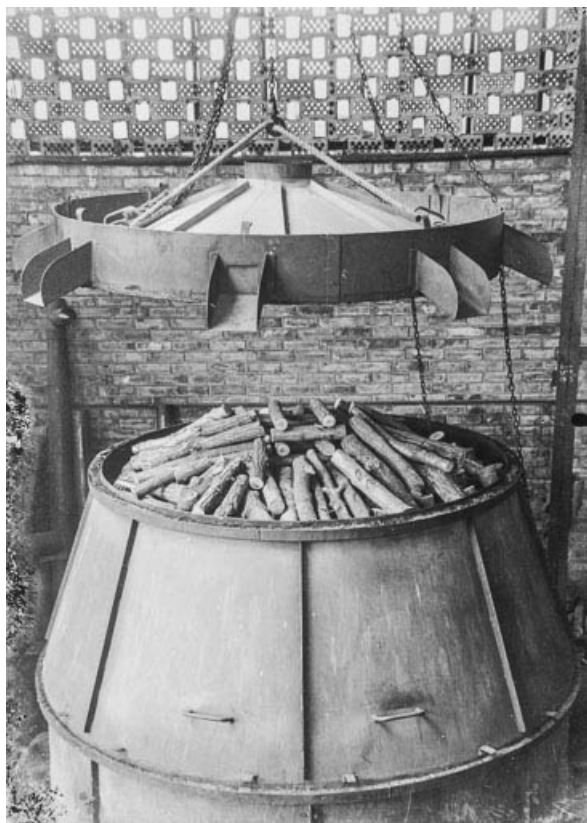
Fabrication de charbon de bois (ou de gaz carbonique ?) : mise en place du couvercle sur la machine.
