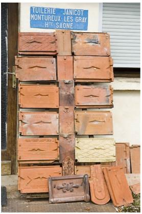
Présentoir de tuiles mécaniques et tuiles plates.
