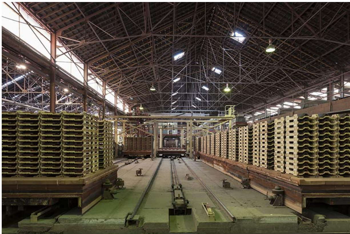
Unité de fabrication dite UL 1. Chariots de four.
