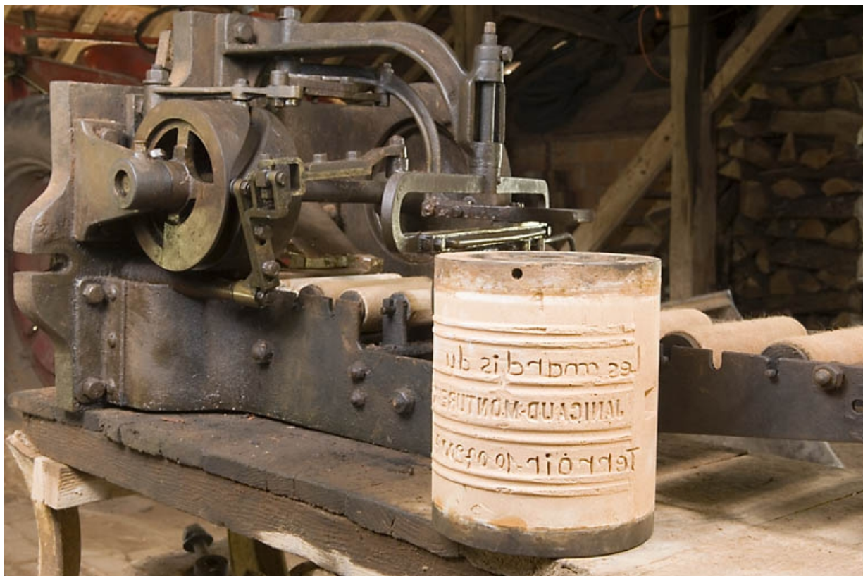
Mouleuse-étireuse pour tuiles et rouleau servant de matrice.
