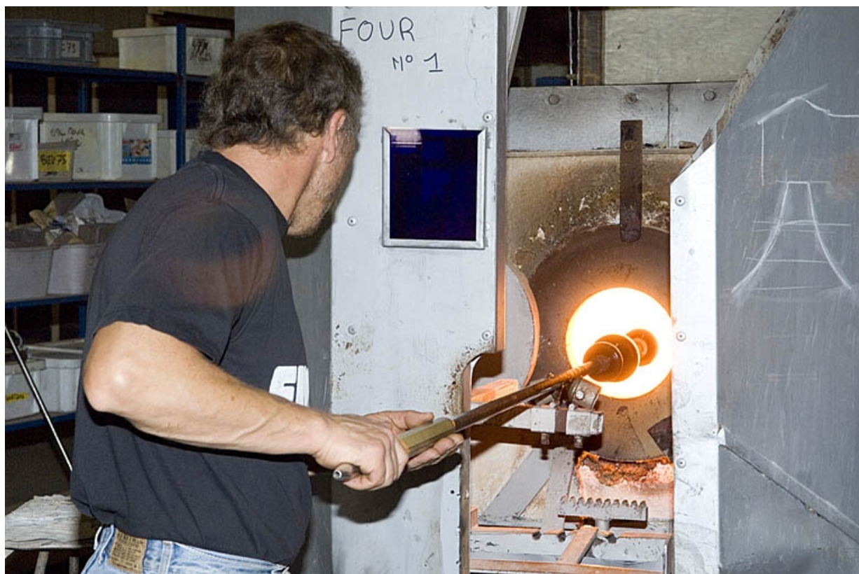
Four à réchauffer.
