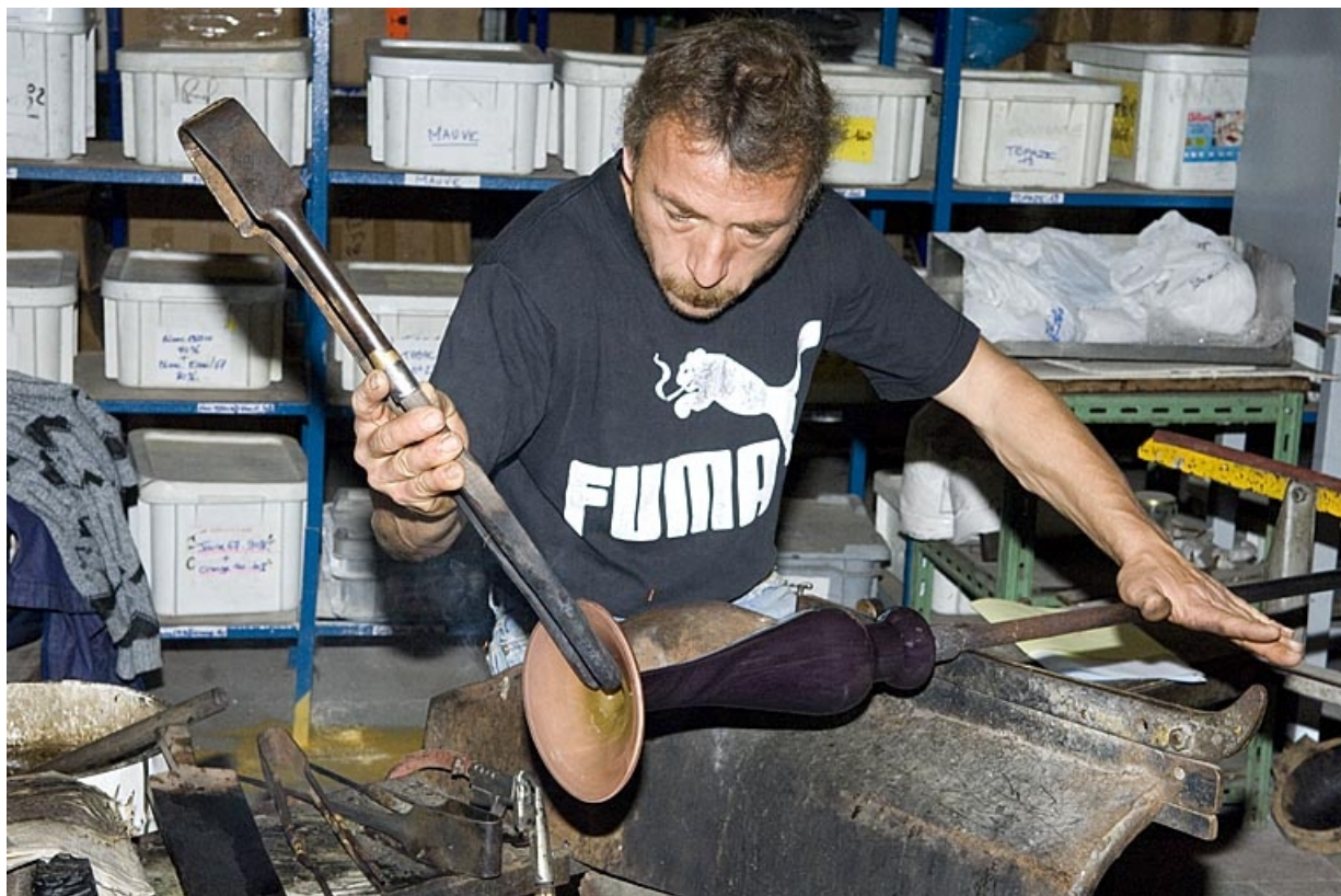
Façonnage du pied de la lampe.
