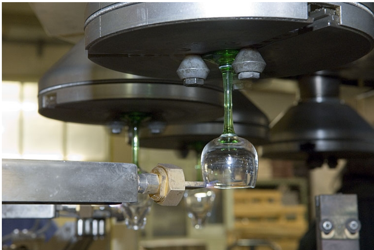
Flettage (ou rebrûlage) des bords d'un verre.
