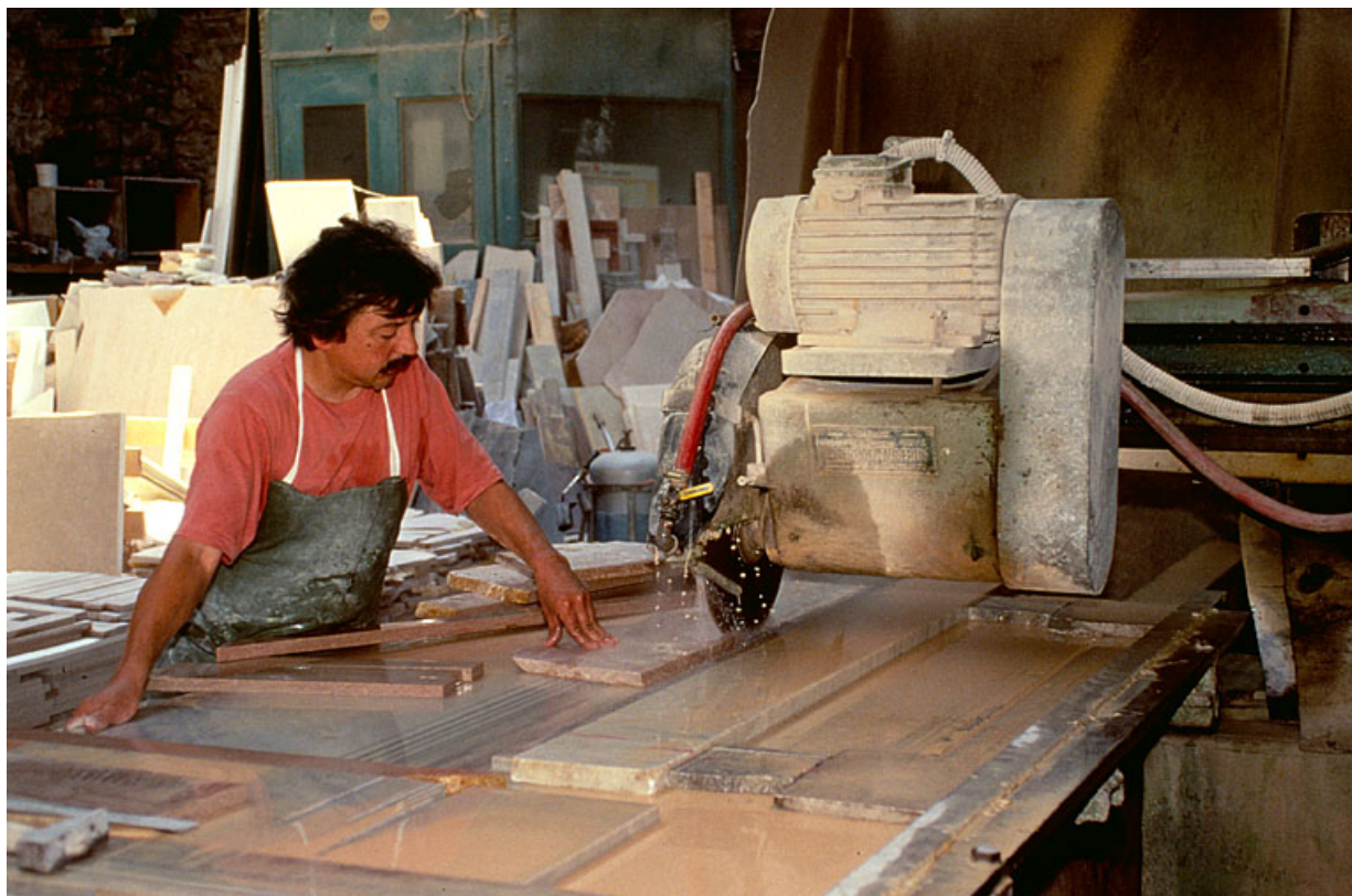
Débitage de plinthes en marbre de Balanod.
