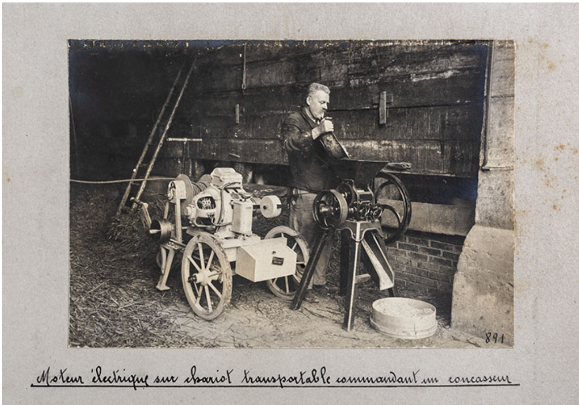
Moteur électrique sur chariot transportable commandant un concasseur, 1ère moitié 20e siècle.
