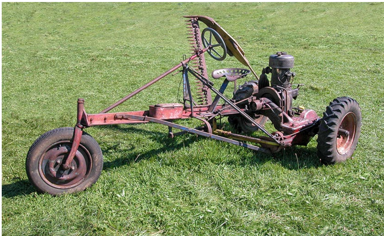
Kiva à moteur à essence Chaise, équipée de sa barre de coupe.
