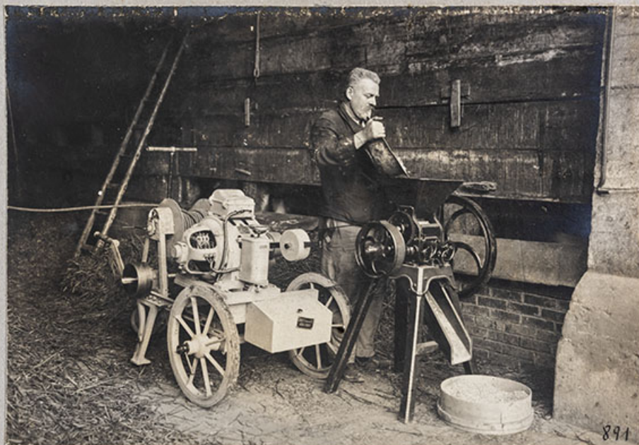
Moteur électrique sur chariot transportable commandant un concasseur
