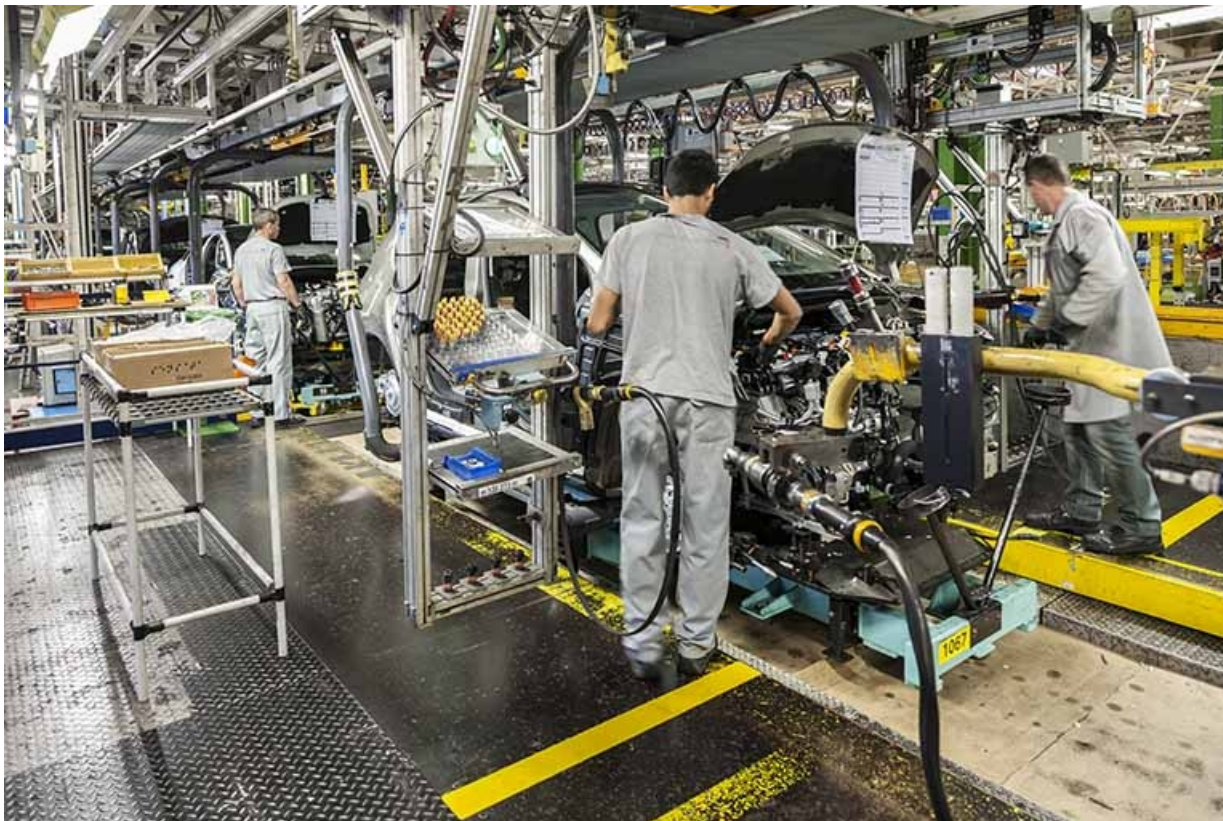
Atelier de montage. Opération de coiffage (2).
