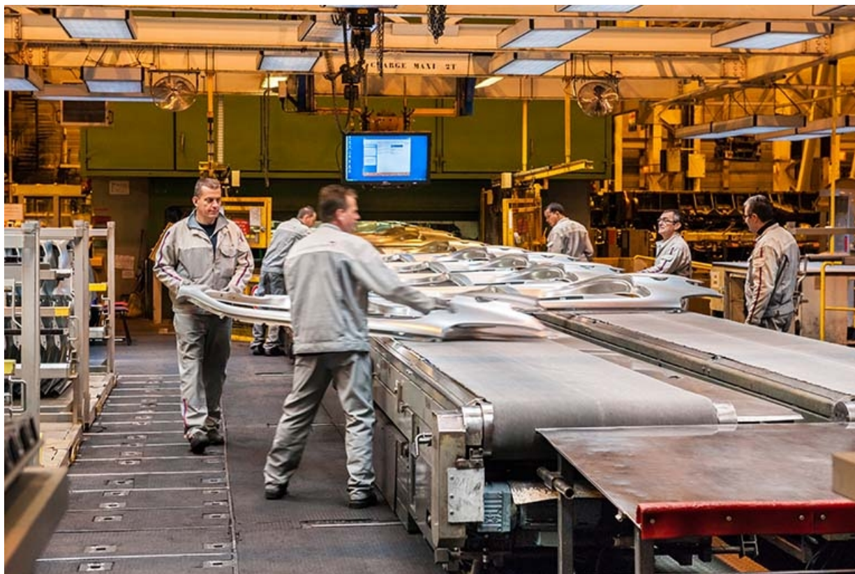
Atelier d'emboutissage. Opérateurs en sortie de presse.
