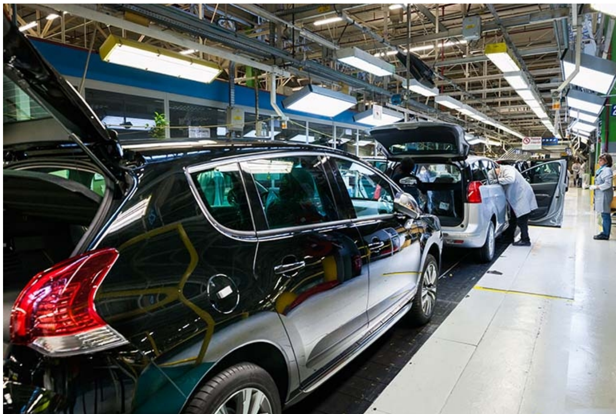
Atelier de montage. Contrôle visuel en fin de ligne.
