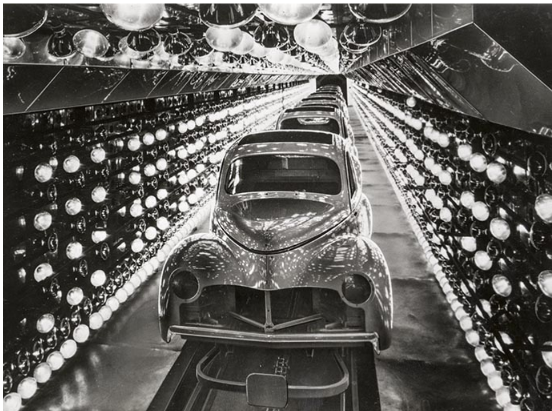
Tunnel de séchage (203).
