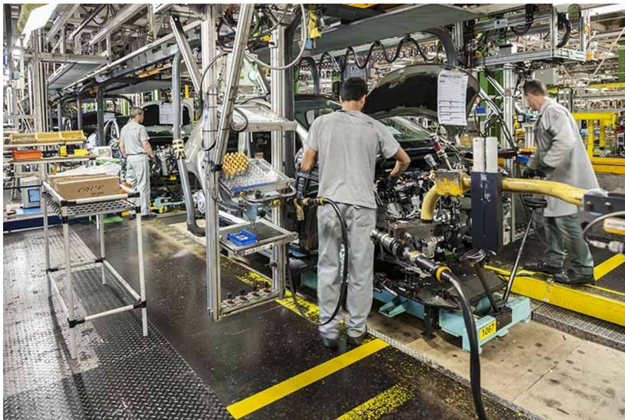
Atelier de montage. Opération de coiffage (2).
