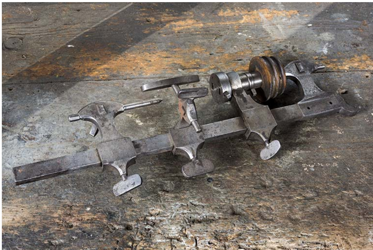
Fabrique d'outillage : exemple de tour à perche. 25, Les Gras
