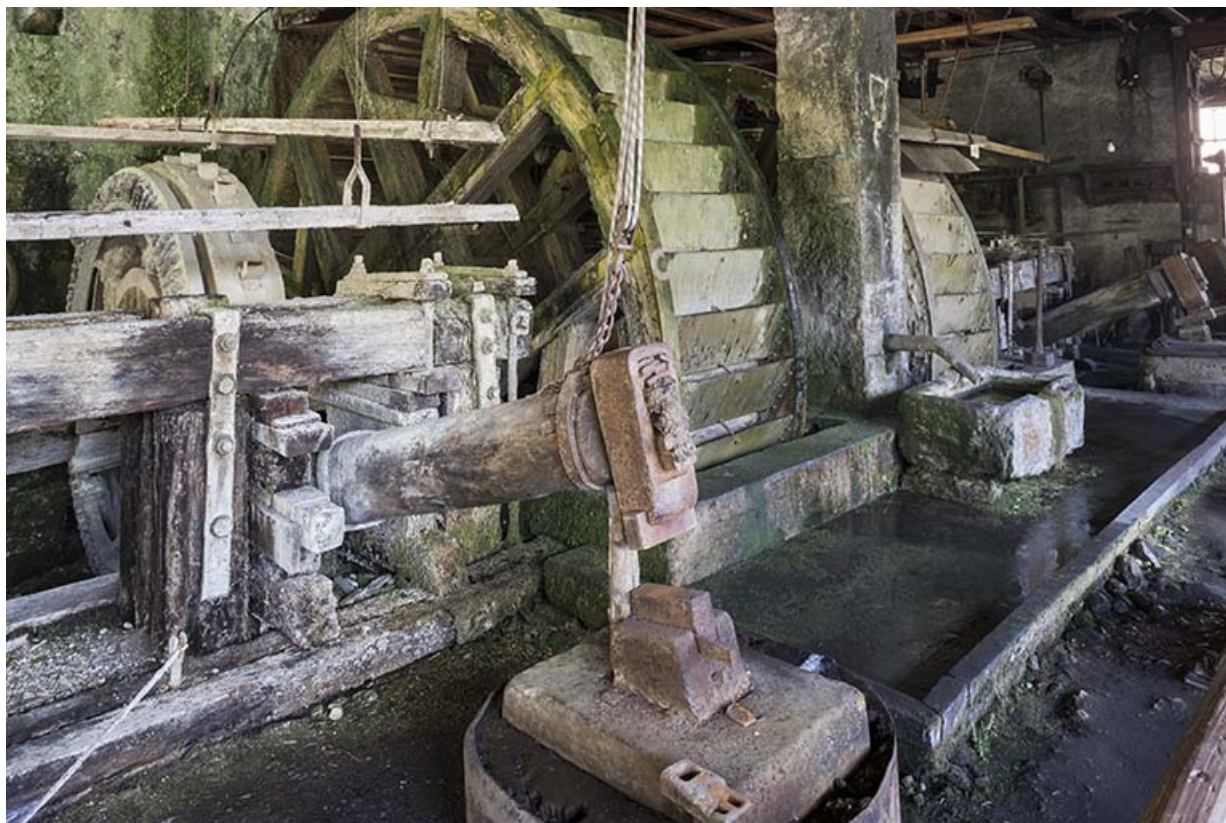
Les martinets et leurs roues motrices.
