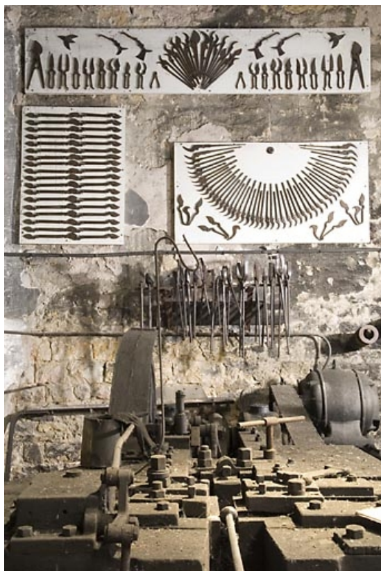
Atelier est. Machine à refouler et panneaux de présentation de sécateurs.
