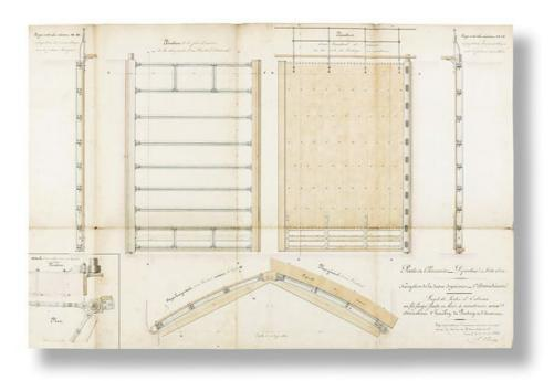
"Projet de Portes d'Ecluses en fer forgé fonte et bois à construire aux dérivations d'Heuilley de Pontcey et d'Auxonne". Plan, coupe et élévation.
