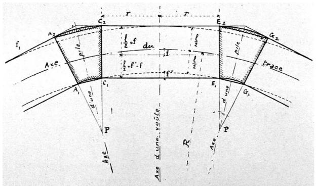
Dispositions en vue de la courbe du tracé [des viaducs], [1919].
