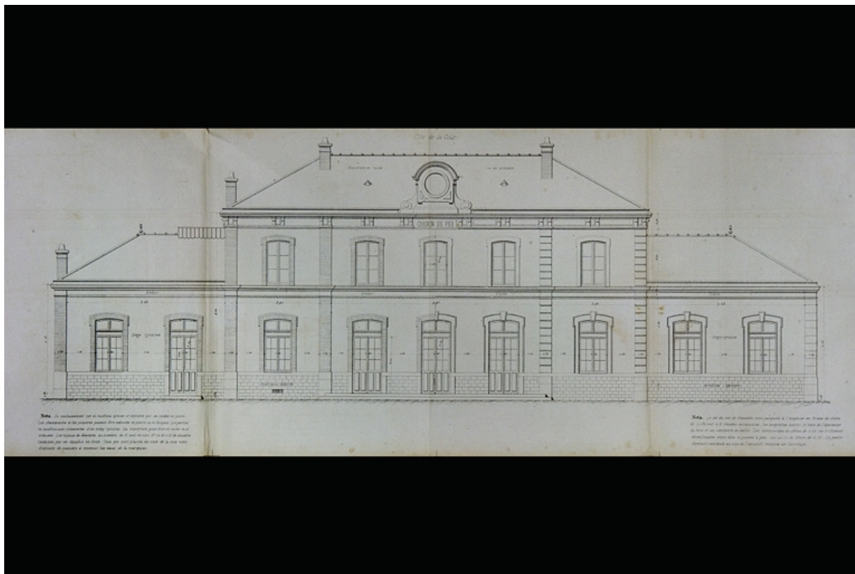
Bâtiment des voyageurs pour Station de 1 re classe. Type de la Cie de Paris - Lyon - Méditerranée. C 1 [élévation antérieure], 1880.
