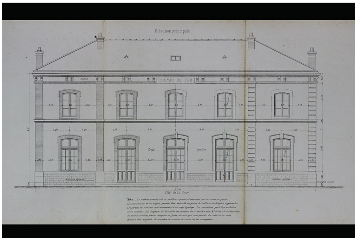
Bâtiment des voyageurs pour Station de 2e classe. Type de la Cie de Paris - Lyon - Méditerranée. C 3 [élévation antérieure], 1880.
