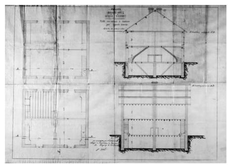
Forges de Franche-Comté. Mine d'Ougney. Plan d'un bâtiment à construire pour logements d'ouvriers [deux travées de la "Caserne"].
