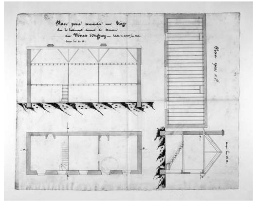
Plan pour remonter un étage sur le bâtiment servant de bureau aux mines d'Ougney.
