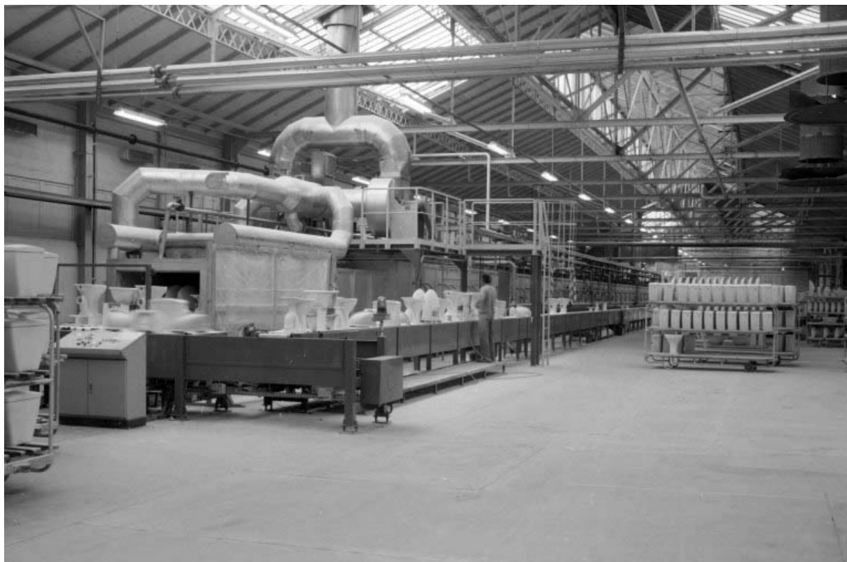
Atelier (9) : avant du four Riedhammer.
