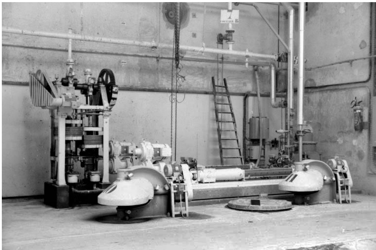
Atelier de préparation de la pâte (9) : pompes à barbotine. Agitateurs à barbotine au 1er plan ; pompe ancien modèle à gauche, pompes nouveau modèle au centre.
