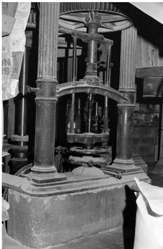
Beffroi : arbre moteur d'une paire de meules et système d'embrayage.
