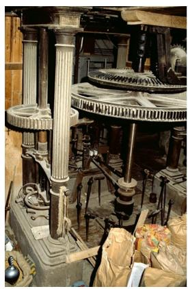
$\label{eq:Beffroi} \textbf{Beffroi: transmission et commandes d'admission d'eau de la turbine.}$
