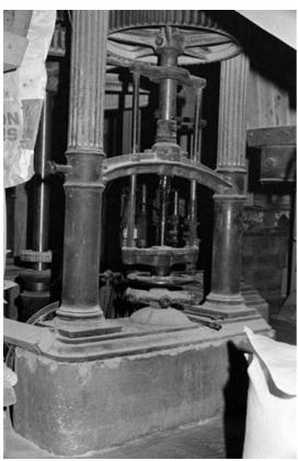
${\bf Beffroi: arbre\ moteur\ d'une\ paire\ de\ meules\ et\ système\ d'embrayage.}$
