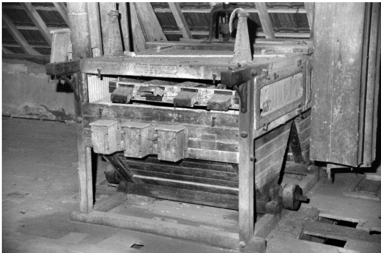
Minoterie, étage de comble : trieur à grains Lacroix.
