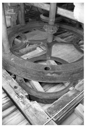
Minoterie, rez-de-chaussée : support des meules et transmission (beffroi). 39, Rahon, 37, 39, 41 rue du Moulin
