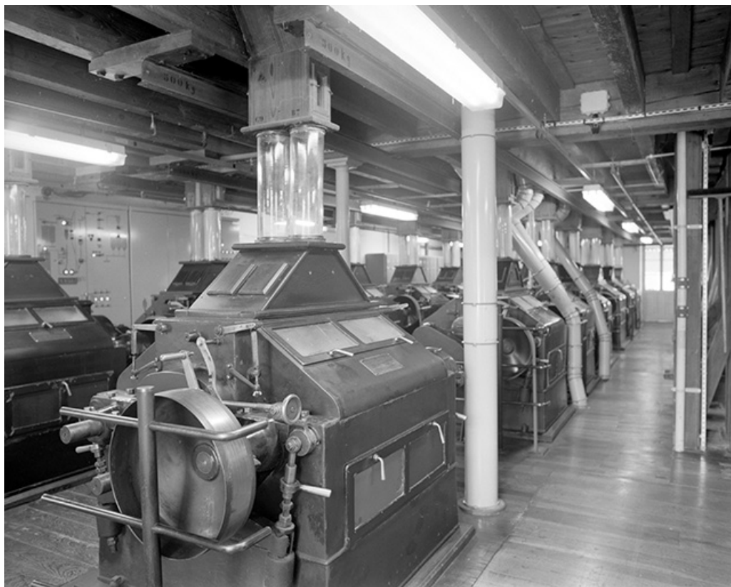
Atelier de fabrication (L), 1er étage : rangée d'appareils à cylindres. 39, Parcey rue du Moulin
