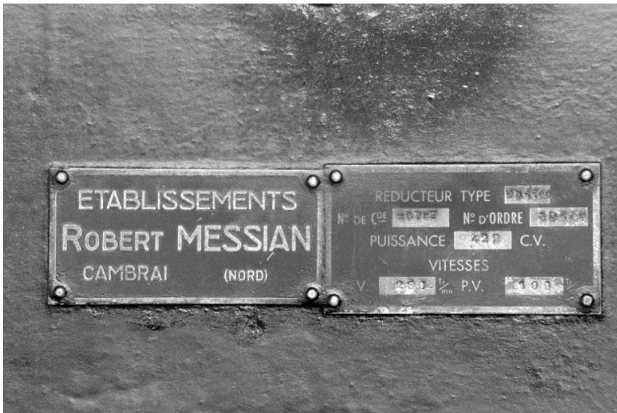
Plaque de constructeur du réducteur Messian.
