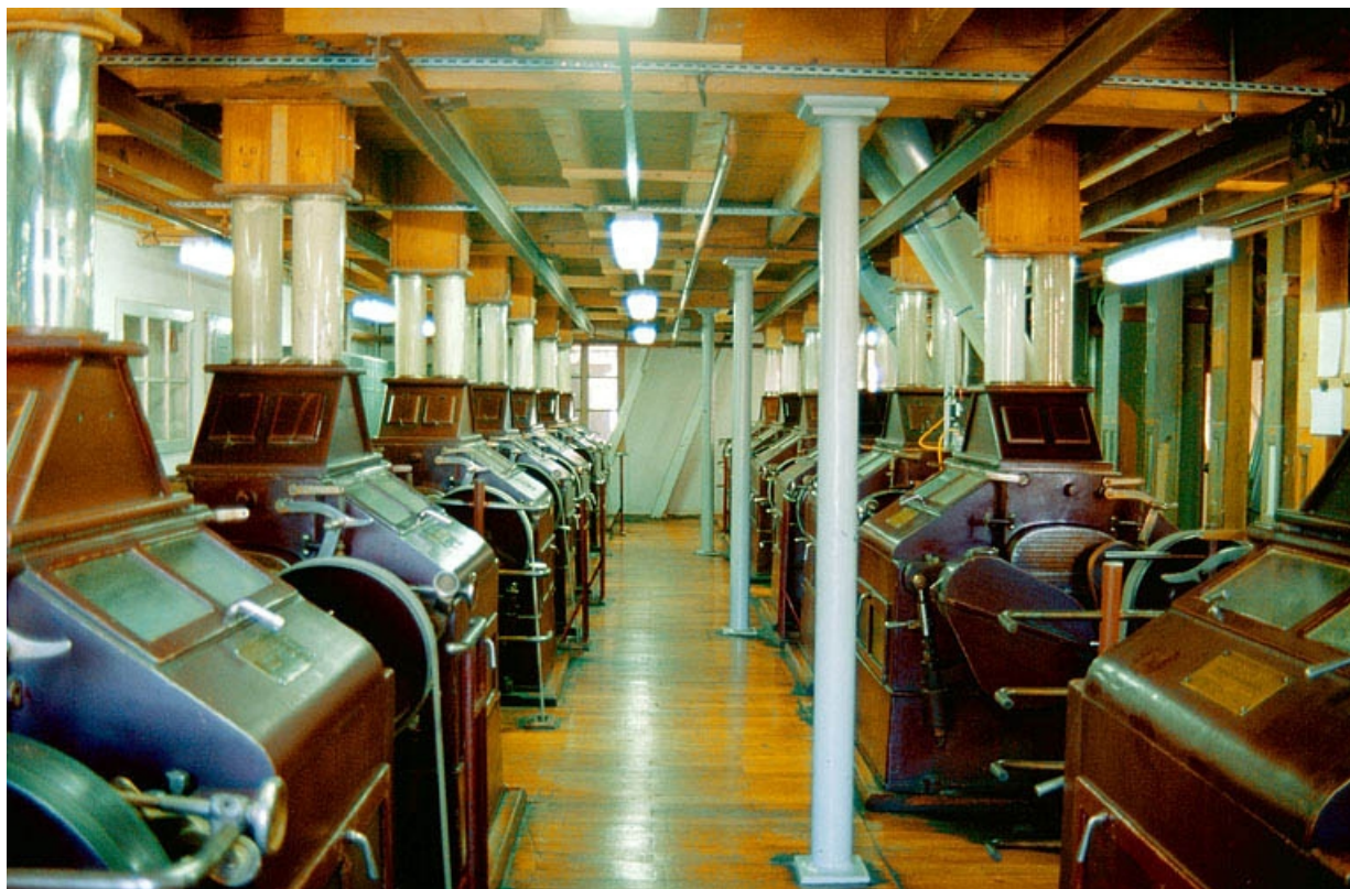
Atelier de fabrication (L), 1er étage : vue d'ensemble des appareils à cylindres. 39, Parcey rue du Moulin
