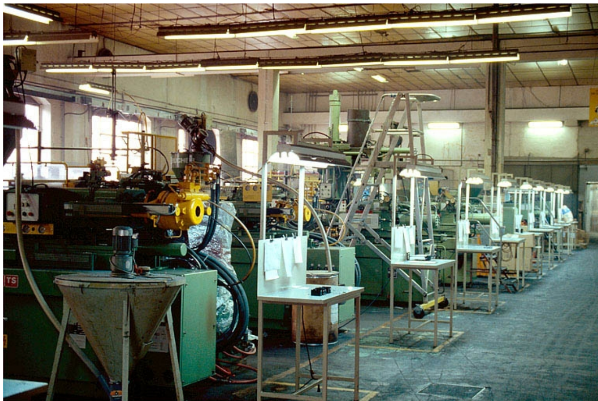
Intérieur de l'atelier de fabrication : presses à injecter.
