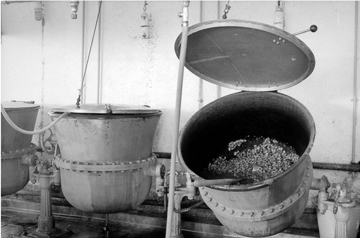
Conserverie Ménétreil, atelier de fabrication (3) : marmites de première cuisson.
