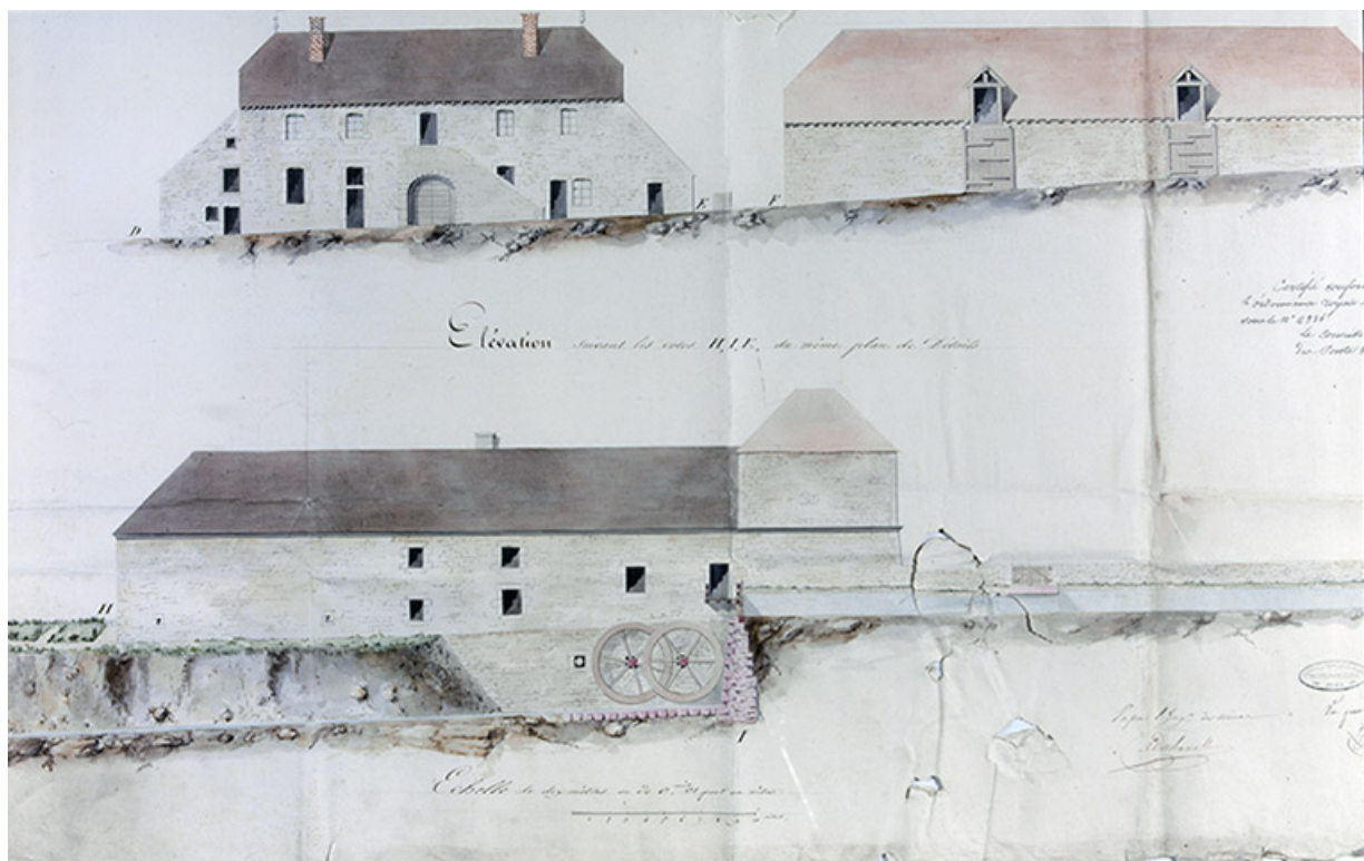
Bâtiment du haut-fourneau en 1827 : élévation postérieure.
