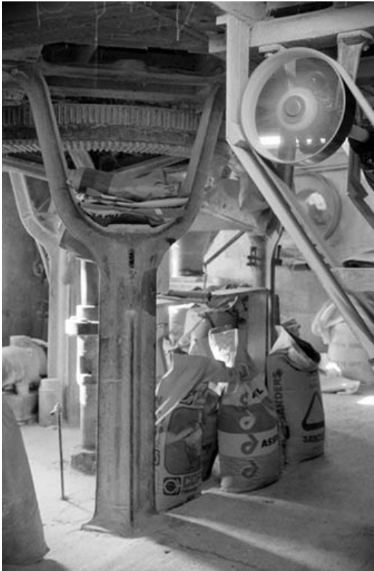
Transmission et support de meules (beffroi).
