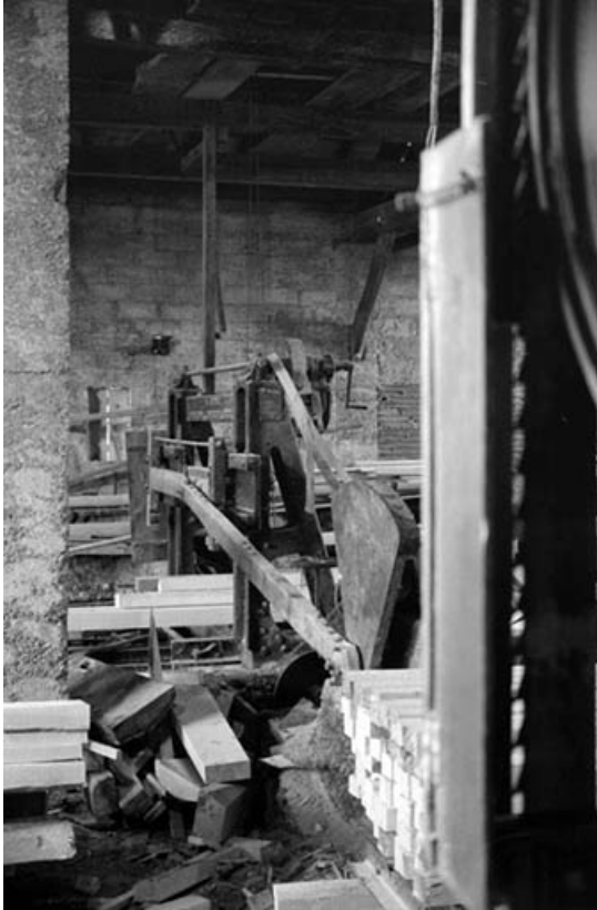
Scie à châssis horizontal, de profil.
