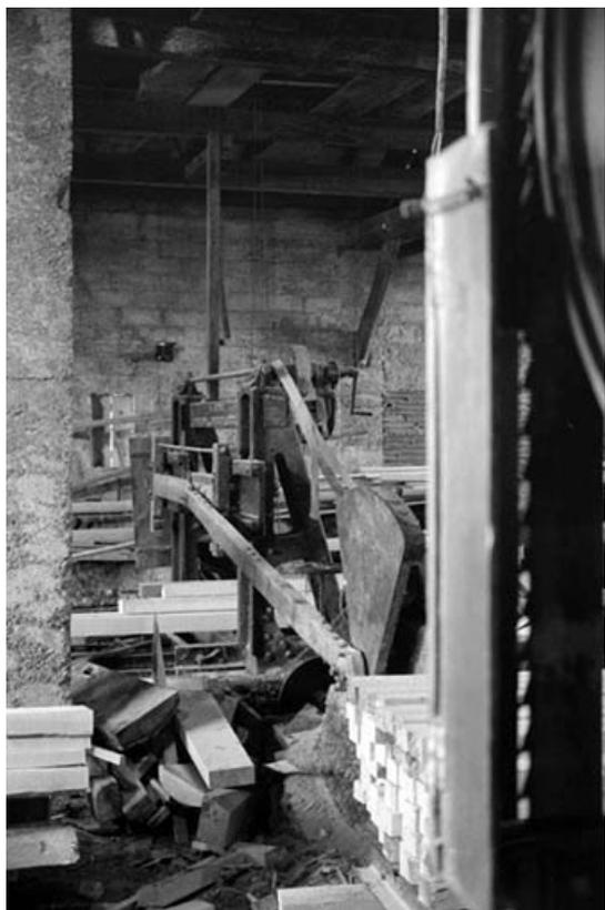
**Scie à châssis horizontal, de profil.**
