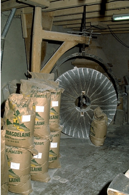
Minoterie (G), rez-de-chaussée : potence et meule. 39, Vaudrey rue du Moulin
