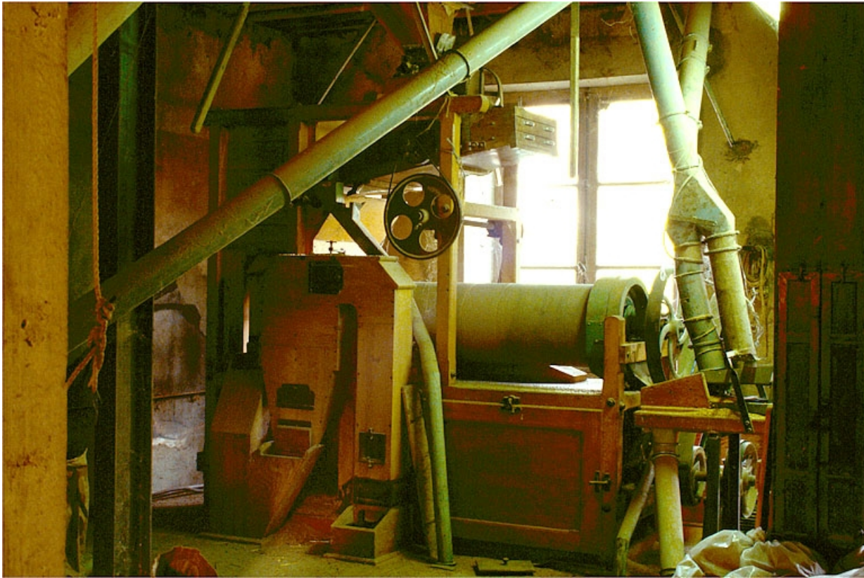
Minoterie (H), rez-de-chaussée : trieur à grains Lhuillier.
