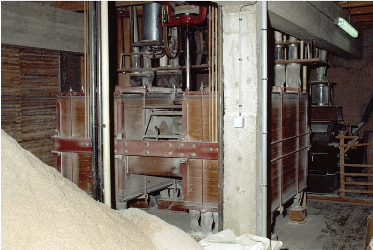
Minoterie (H), rez-de-chaussée : plansichter. 39, Vaudrey rue du Moulin
