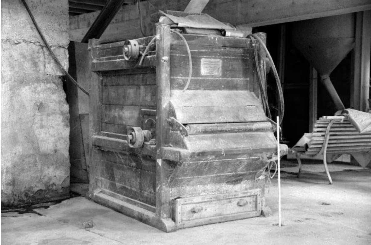
Minoterie (H), étage de soubassement : nettoyeuse à sacs Lhuillier. 39, Vaudrey rue du Moulin
