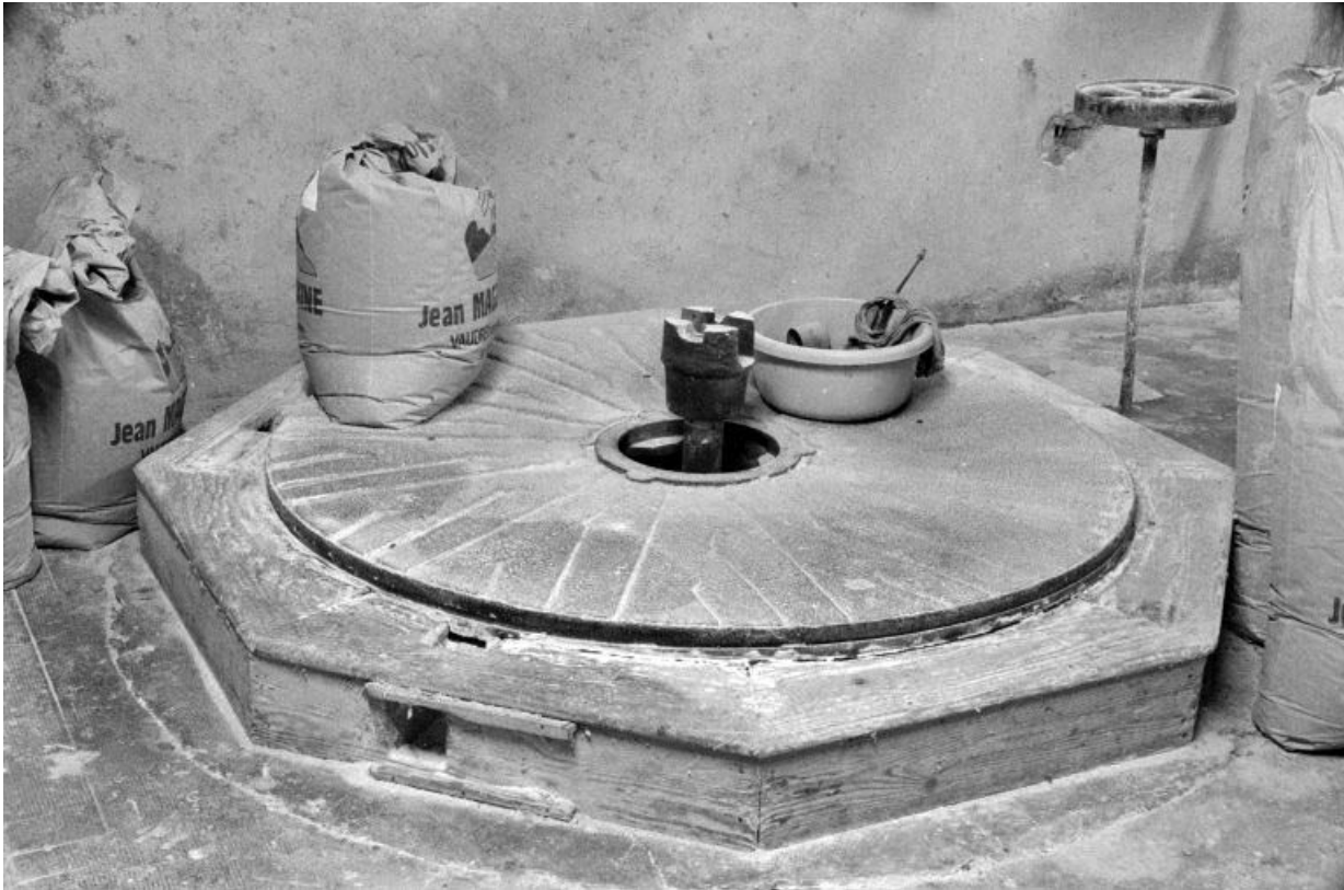
Minoterie (G), rez-de-chaussée : meule inférieure en cours de rhabillage. 39, Vaudrey rue du Moulin
