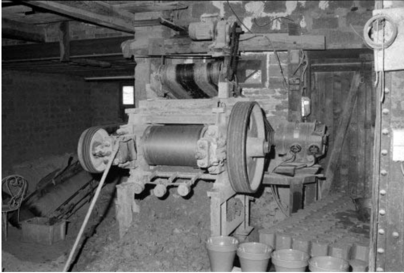
Broyeur UNICERAM (5). A droite, pâtons au sortir de la boudineuse et avant moulage. 39, Étrepigny rue Haute
