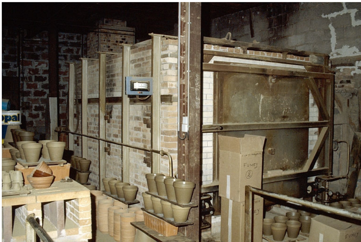
Four au fuel à flamme renversée (10). 39, Étrepigney rue Haute
