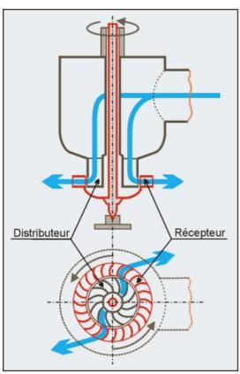
Schéma de principe de la turbine Fourneyron.
