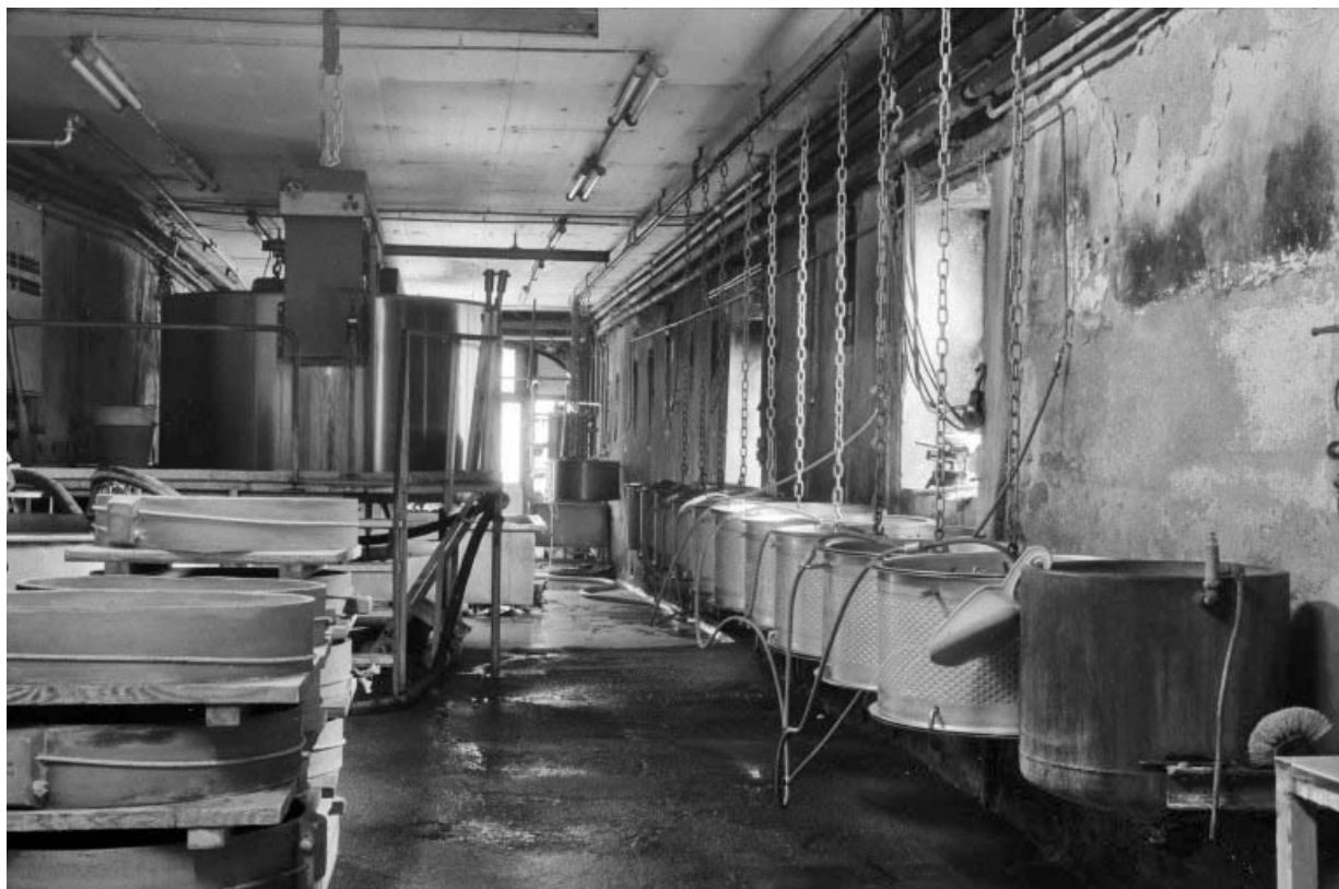
Intérieur de l'atelier de fabrication. A droite les presses hydrauliques, à gauche et au premier plan les cercles, en arrière-plan les 2 cuves multiples.
