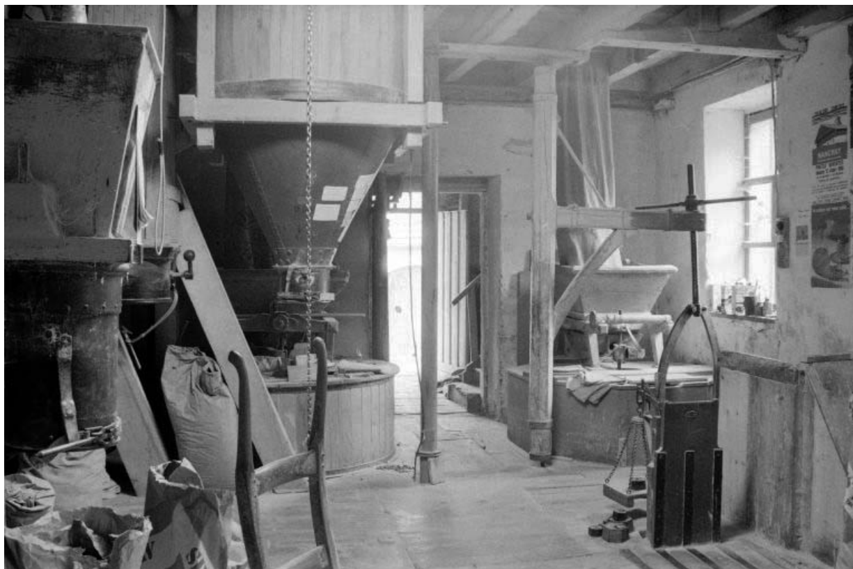
Intérieur : rez-de-chaussée, salle des meules. Trémie à farine à gauche et potence à droite, en avant des deux paires de meules. 39, Rans, lieudit : Moulin de la Bruyère
