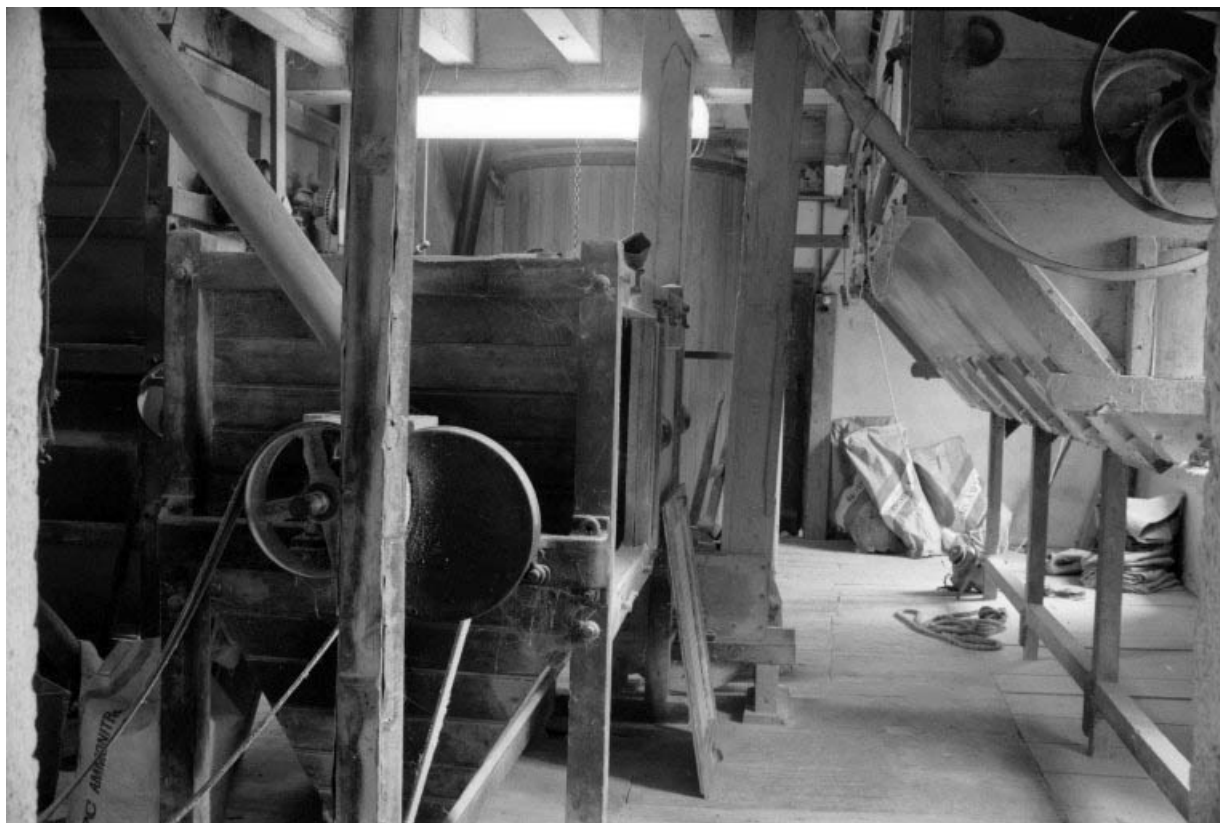
Intérieur : étage, salle de la bluterie. A droite extracteur à 6 pans, à gauche bluterie centrifuge, en arrière-plan mélangeur à farines. 39, Rans, lieudit : Moulin de la Bruyère
