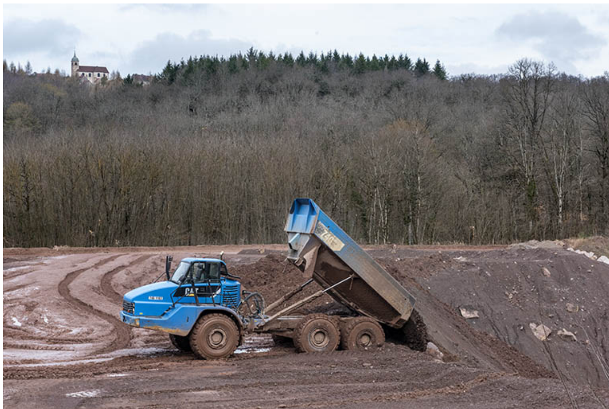
Carrière : évacuation des morts terrains à l'aide d'un camion articulé.
