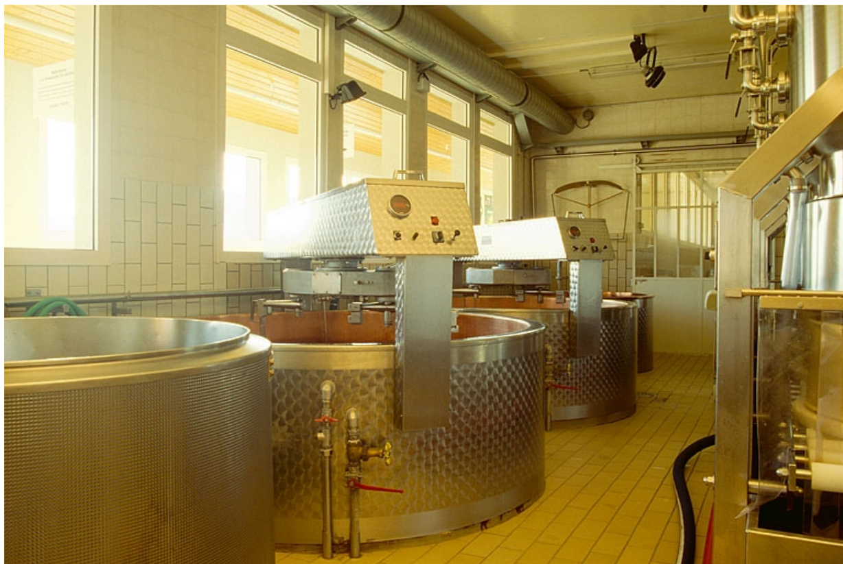
Cuves de fabrication du comté.
