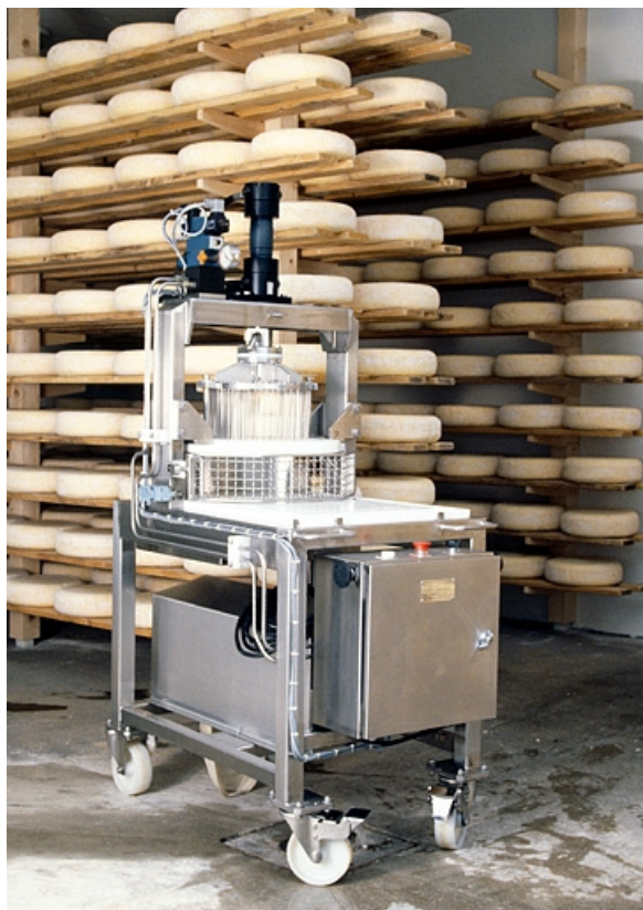
Machine à piquer les fromages.
