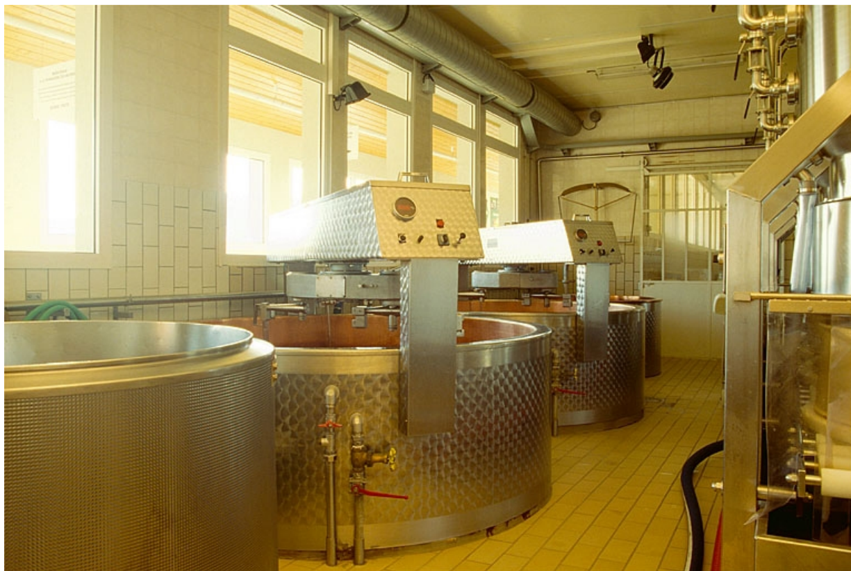
Cuves de fabrication du comté.
