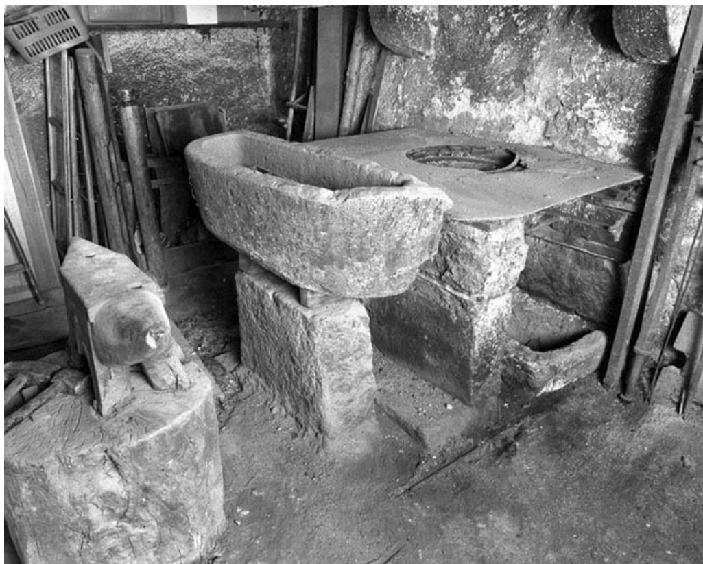
Intérieur de la forge, le foyer, l'enclume, le cendrier, la pierre à eau.
