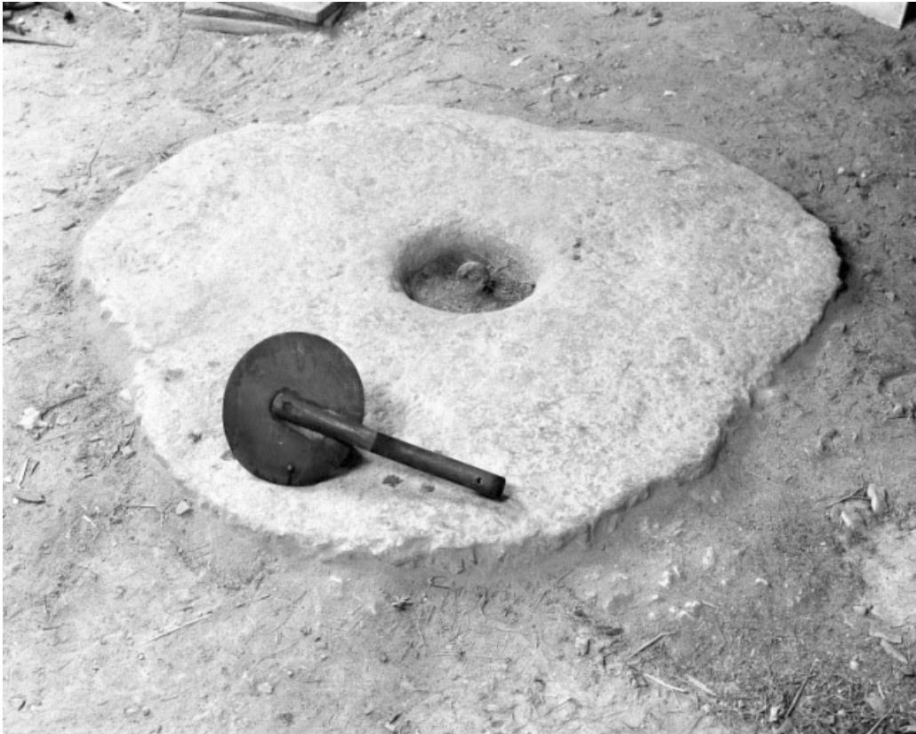
Appareil servant à mesurer les circonférences.
