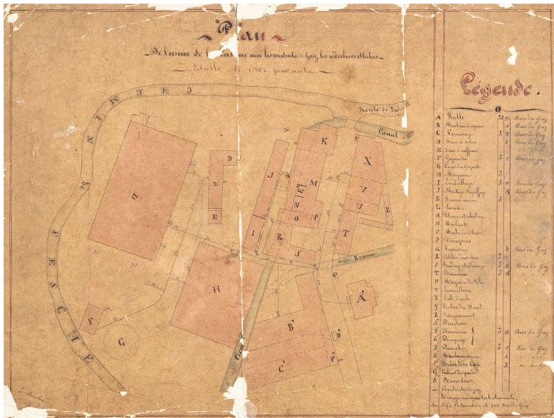
Plan de l'usine de la Casserie avec les conduites de gaz, les réverbères et les becs.
