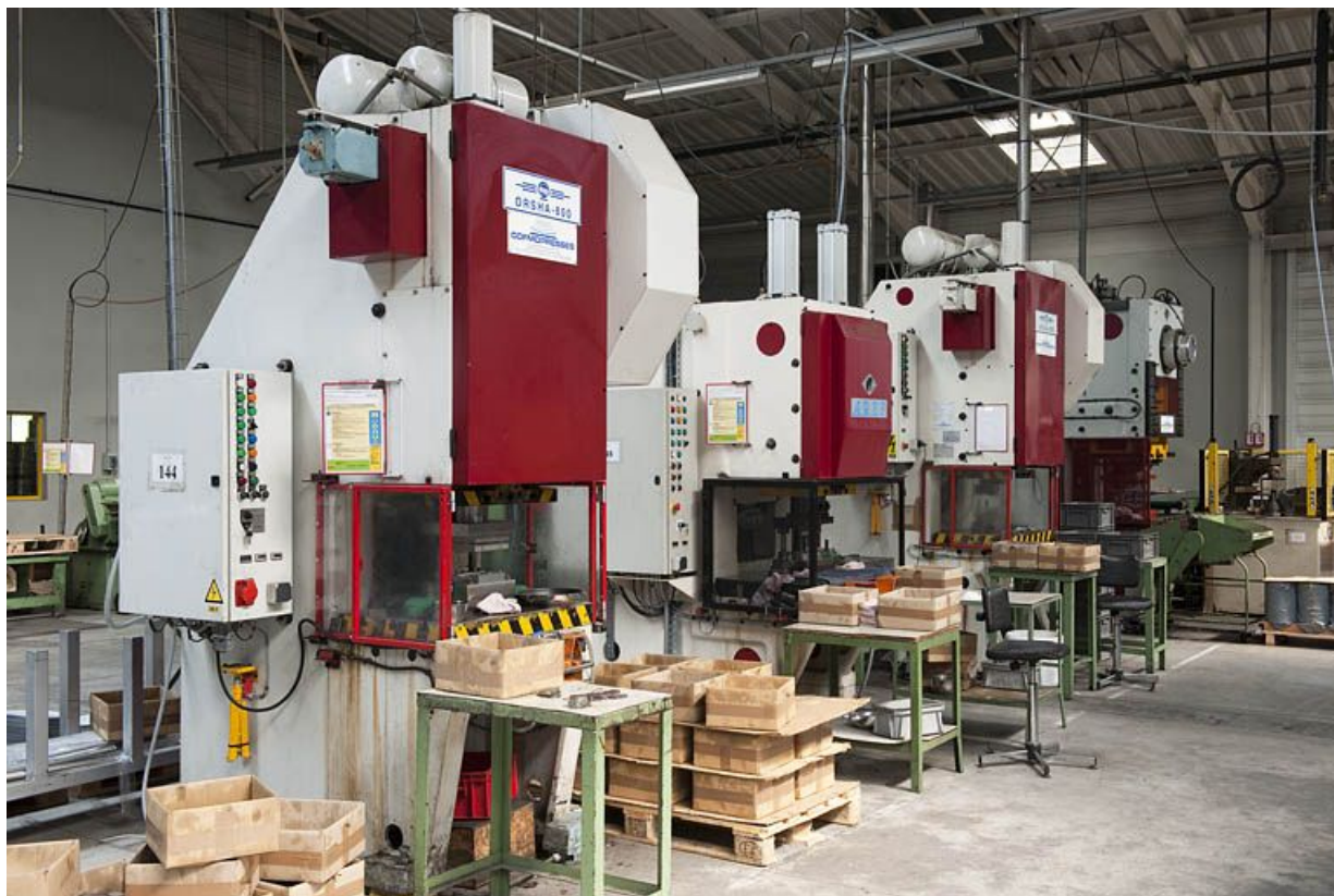
Atelier d'emboutissage. Batterie de presses. 25, Fesches-le-Châtel
