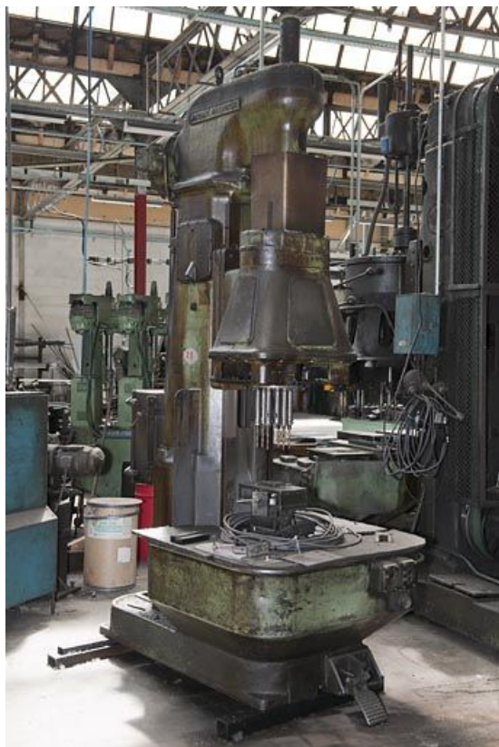
Perceuse multiple à colonne André Citroën. Vue de trois quarts. 25, Dampierre-les-Bois rue des Etains, lieudit : la Feschotte du Haut
