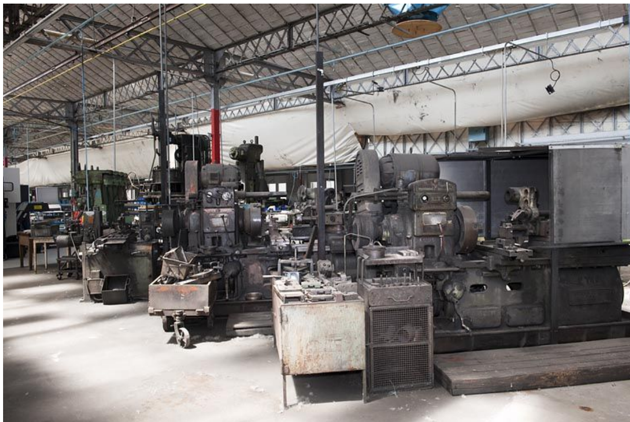
Machine double à fraiser Somua et tours horizontaux américains Potter et Johnston (hors-service). 25, Dampierre-les-Bois rue des Etains, lieudit : la Feschotte du Haut
