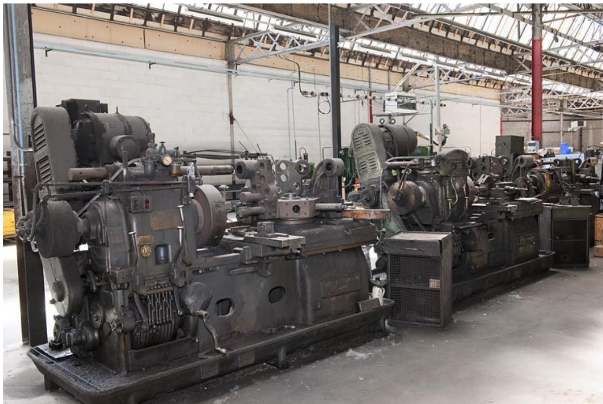
Tours horizontaux américains Potter et Johnston (hors-service). 25, Dampierre-les-Bois rue des Etains, lieudit : la Feschotte du Haut
