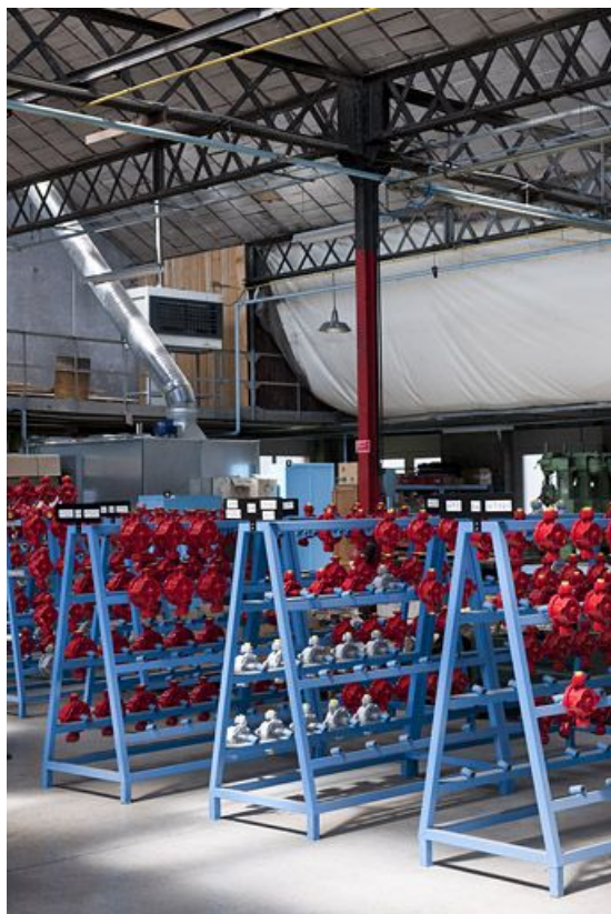
Atelier de fabrication. Portiques de séchage des corps de pompes. 25, Dampierre-les-Bois rue des Etains, lieudit : la Feschotte du Haut
