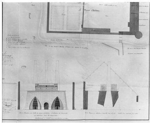
Plan d'un haut-fourneau que MM. [...] se proposent de construire au Vieux Château de Valay [détail de la partie gauche : élévation et counel.
