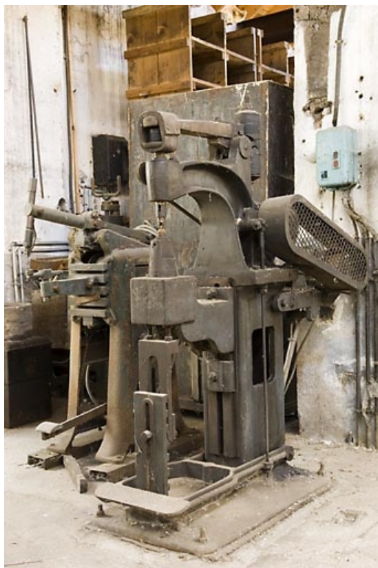
Atelier ouest. Riveteuses Pontelec et Guillemin.
