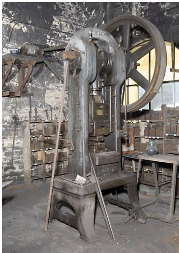
Atelier est. Presse à cisailer Bliss.
