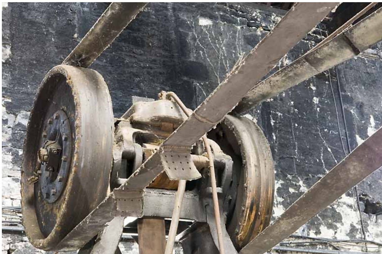
Atelier est. Marteau-pilon. Détail de la transmission supérieure par poulies et courroies. 70, Pesmes, lieudit : les Forges
