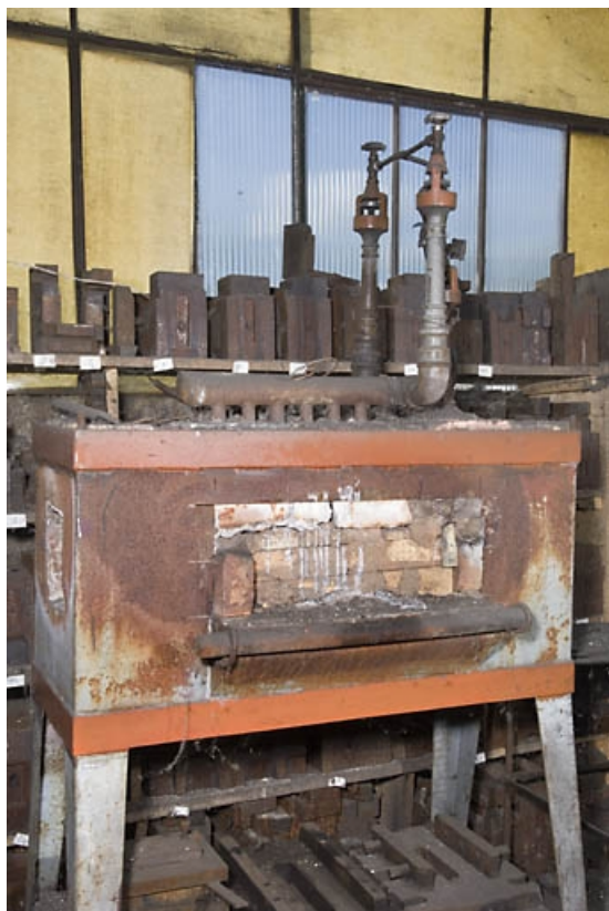
Atelier est. Four à gaz Thermidor.
