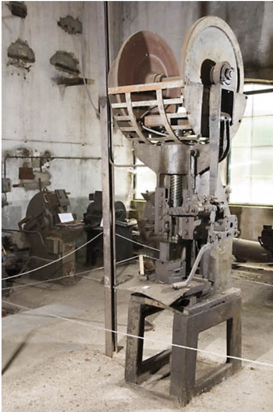
Atelier ouest. Presse à friction.
