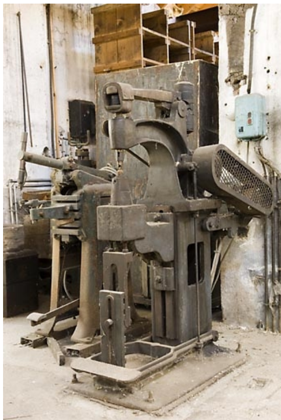
Atelier ouest. Riveteuses Pontelec et Guillemin.
