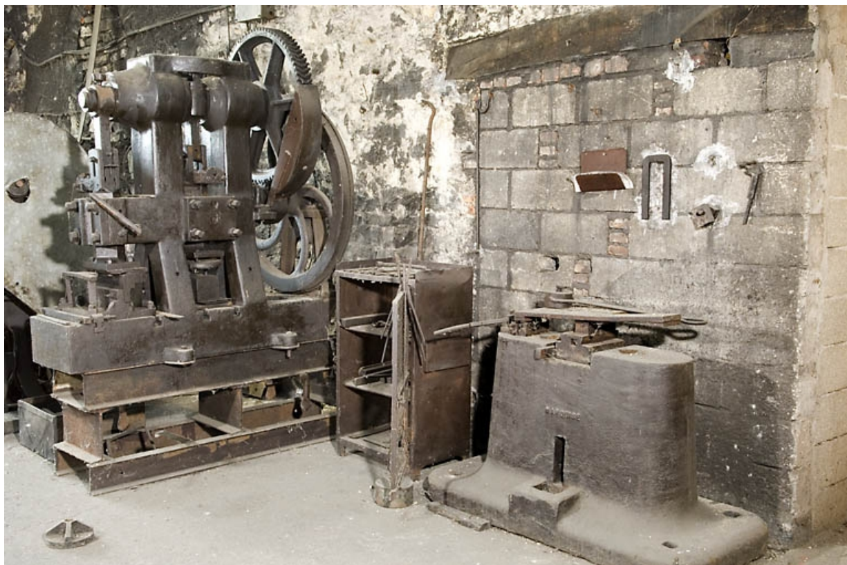
Atelier est. Découpoir et machine à couder Marquise (barres de fer). 70, Pesmes, lieudit : les Forges
