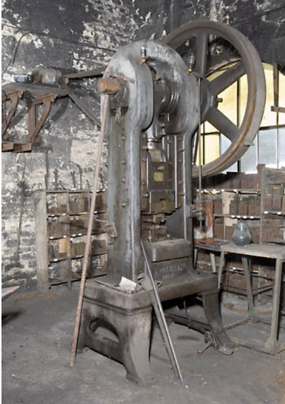
Atelier est. Presse à cisailer Bliss.
