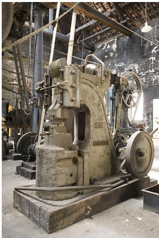
Atelier est. Martinet à ressorts de la Société de Constructions de Montbard. 70, Pesmes, lieudit : les Forges
