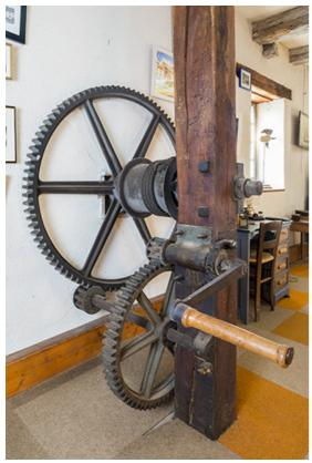
Premier étage. Détail de système de levage de la roue suspendue (amont). 25, Vuillafans, 14, 16 route de Pontarlier
