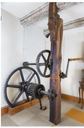
Premier étage. Système de levage (par manivelle et chaîne) de la roue suspendue (aval). 25, Vuillafans, 14, 16 route de Pontarlier
