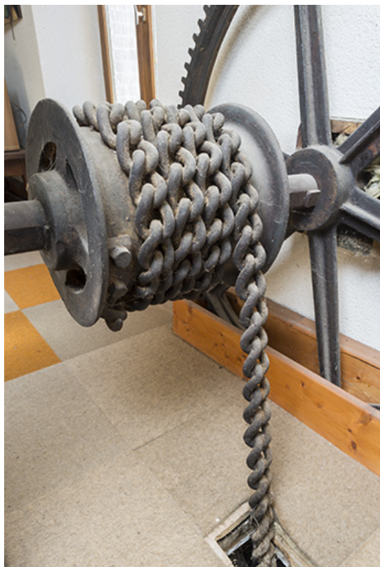
Système de levage de la roue suspendue (aval). Détail du mécanisme d'enroulement de la chaîne. 25, Vuillafans, 14, 16 route de Pontarlier
