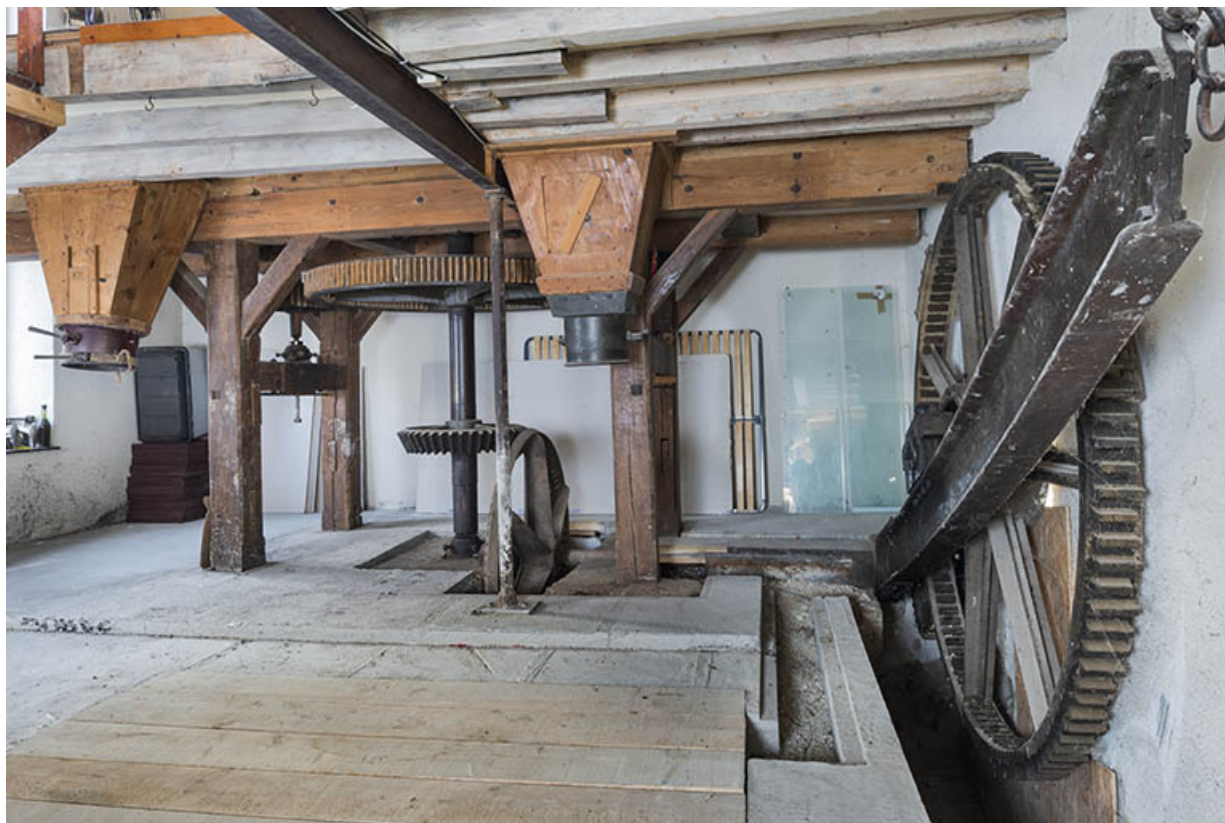
Partie sud du rez-de-chaussée : beffroi des meules et mécanisme de levage de la roue (amont). 25, Vuillafans, 14, 16 route de Pontarlier
