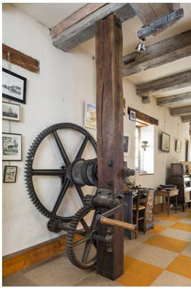
Premier étage. Système de levage (par manivelle et câble) de la roue suspendue (amont). 25, Vuillafans, 14, 16 route de Pontarlier
