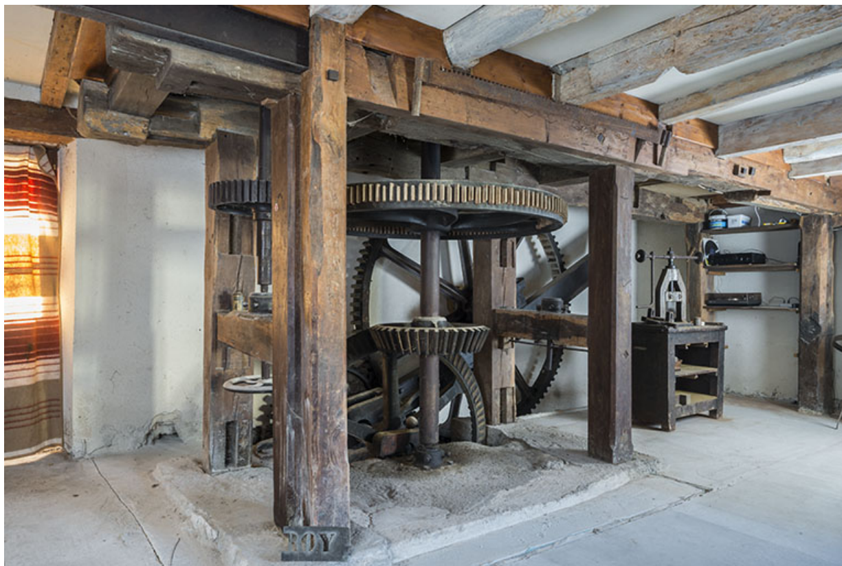
Rez-de-chaussée : beffroi (ouest) des meules.
