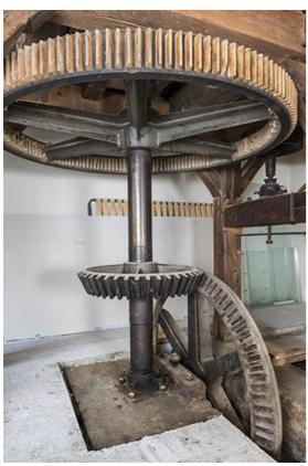
Beffroi des meules (est) et système de transmission par engrenages. 25, Vuillafans, 14, 16 route de Pontarlier
