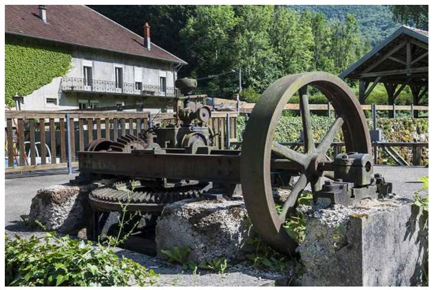
Engrenages et volant de transmission de la turbine.
