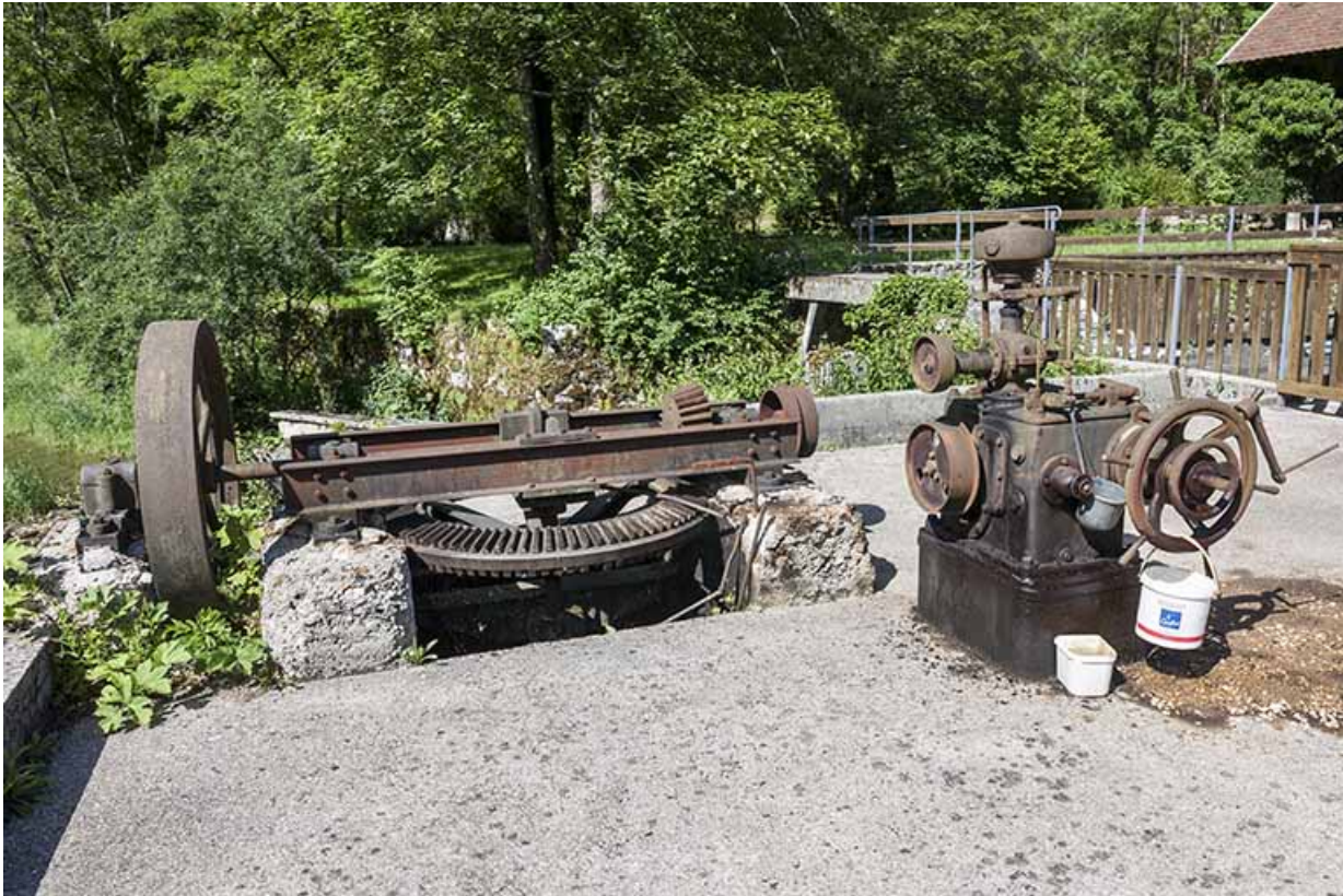
Transmission à l'aplomb de la turbine (à gauche) et régulateur Goulut-Borne. 25, Lods, 41 route de Besançon
