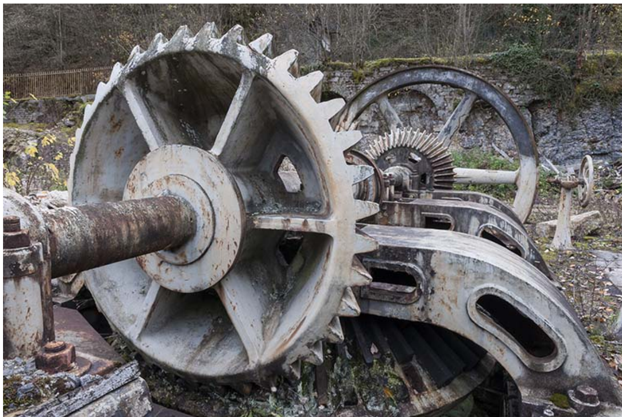
Turbine double. Transmission par engrenage conique.
