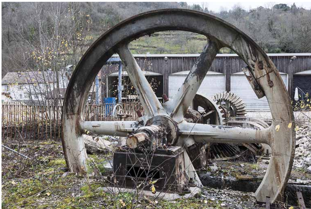
Volant d'inertie de la turbine.
