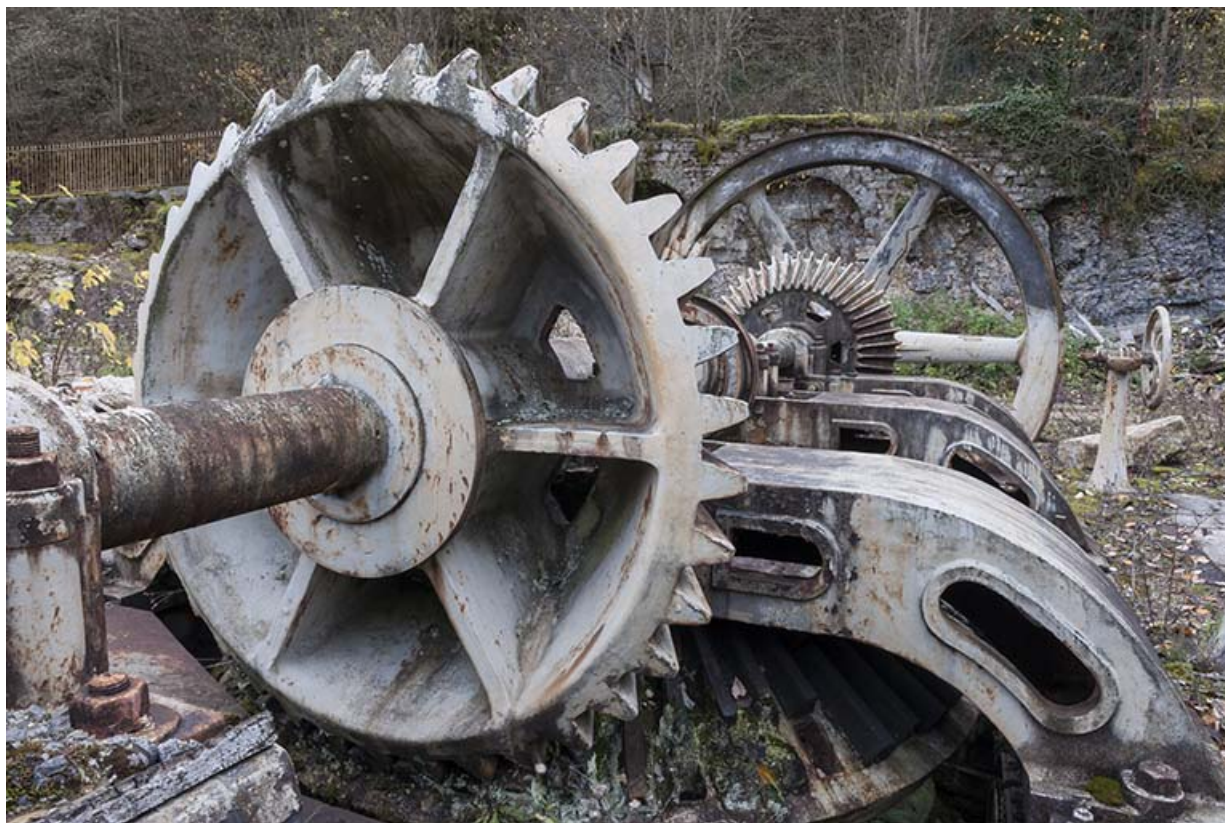
Turbine double. Transmission par engrenage conique.
